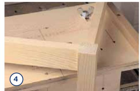
... etwas nach hinten verschoben werden. Zum Schluss den Zapfen an einer Schmalkante noch ein wenig "absetzen", damit er etwas über die Gratnut geschoben werden kann.
