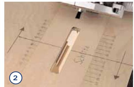
Danach spannen Sie die Zargen hochkant in die Vorrichtung und verschieben den Schablonenträger so, dass Sie an der vorderen Kante einen einseitigen Grat anfräsen.
