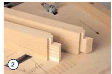
... Brettchen als Begrenzung eingelegt und mit der Kopierhülse abgefahren. Zum Schluss wird der Zapfen z. B. bei einem Tischgestell noch um 45° abgeschragt.
