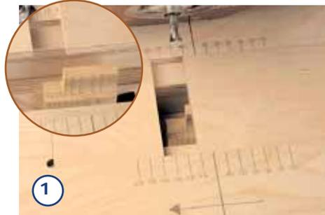
Zunächst einen normalen Zapfen anfräsen. Dann die Frästiefe um 6 mm verringern und den Zapfen mit einer Ausklinkung versehen. Dazu werden einfach zwei passende ...
