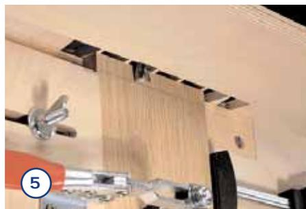
5 Auch das Zinkenbrett sollte genau unter der Schablone vermittelt und mit Schnellspanner und MFT-Spannelement fixiert werden.
