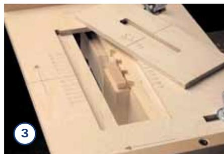
Danach wird die Zarge gedreht und auch die andere Kante angefräst. Testen Sie, ob Gratfeder und Nut passen. Sitzt die Feder zu stramm, muss der Schablonenträger ...
