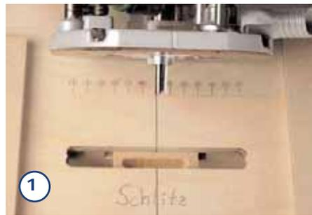
Werkstück hochkant einspannen und zuerst einen Schlitz in die Stirnkanten fräsen. Lassen Sie am Ende noch je ca. 5 mm Material stehen.
