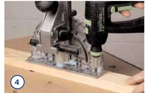
Am Preciso-Anschlag befinden sich außen zwei Löcher. Schrauben Sie dort den Holzanschlag mit zwei Spaxschrauben fest.
