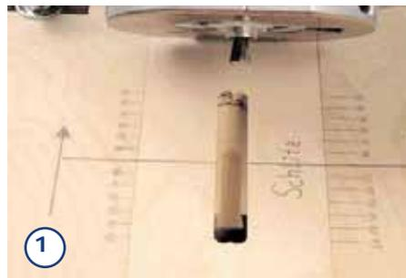
Spannen Sie zuerst den Fußstollen in die Vorrichtung und fräsen Sie mit Hilfe der Schlitzschablone eine Gratnut, die ca. 3-5 mm kürzer ist als die Zargenbreite.
