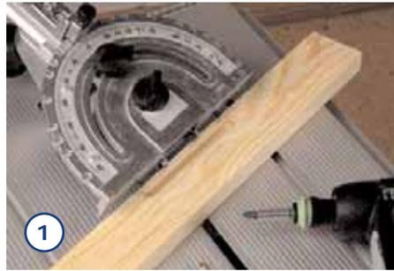
Damit Sie einen Holzanschlag an den Preciso-Anschlag schrauben können, müssen Sie zuerst auf der Rückseite eine Nut einfräsen.
