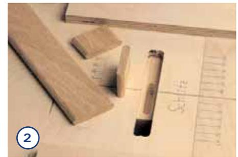
Dann fräsen Sie den gleichen Schlitz in das Gegenstück. Danach müssen Sie nur noch den losen Zapfen als Verbindung einstecken.
