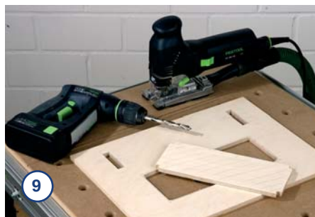
9. Sägen Sie mit der Stichsäge die Längslöcher für die Schlossschrauben genau aus, während Sie die Aussparung für die Schablone nur grob aussägen. Sägen Sie wieder ca. 3 mm bis an den Bleistifttriss heran.
