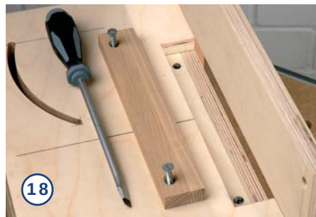
18. Das Ausreißholz muss exakt die gleiche Holzstärke haben wie die Frontplatte. Nach dem Festschrauben müssen beide Teile eine glatte Fläche ergeben.
