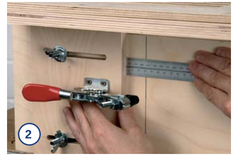
2. Danach richten Sie den Anschlag zur Mittellinie auf die halbe Holzbreite aus.
