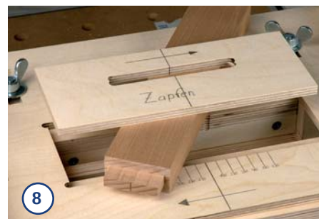
8. Das Schablonenbrettchen einmal links und einmal rechts in der Aussparung angelegt, erzeugt den nötigen 5 mm abgesetzten Zapfen.
