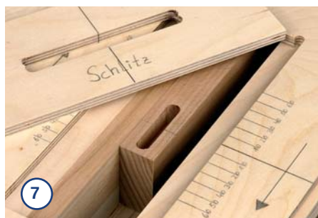
7. ... Platten können einfach lose gegen die Führungshölzer gelegt werden. Das garantiert immer perfekte, gleich lange Schlitzte.
