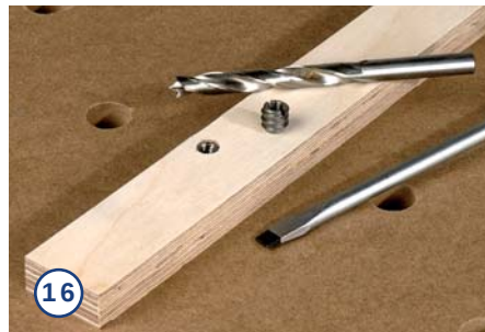
16. Für die Eindrehmuffe ca. 100 mm vom Ende und 10 mm von der Kante der Multiplexleiste ein 10 mm Loch bohren. Anschließend die Muffe möglichst senkrecht ins Holz eindrehen.
