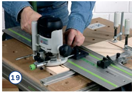
19. Die drei 100 mm langen und 8 mm breiten Schlitzte werden am besten mit der Oberfräse und einer Anschlag-schiene gefräst. Achten Sie unbedingt auf rechtwinklige und parallele Schlitzte. Zur Not ...
