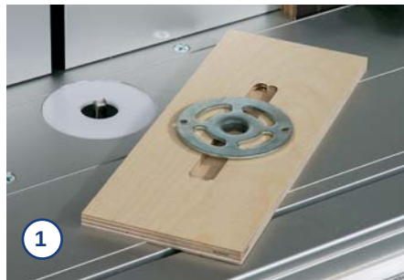
1. Fräsen Sie mit einem 10 mm Nutfräser genau mittig einen 130 mm langen Schlitz, in der die Kopierhülse spielfrei hin- und herläuft.
