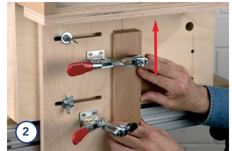
2. ... nach oben, bis es dicht an der Schablone anliegt und arretieren Sie es mit der oberen Schnellklemme.
