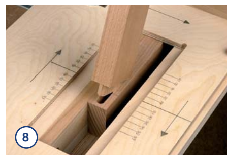
8. Zum Schluss wird der Zapfen an den Kanten mit einem Stechbeitel abgeschragt und in den Schlitz eingesteckt.
