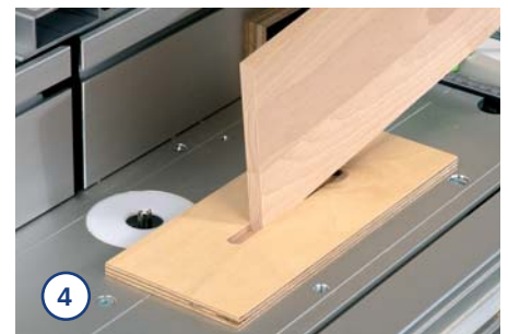
4. Für die Zapfenschablone fertigen Sie sich ein Massivholzbrett an, dass genau in den 10 mm Schlitz ihres Nutfräasers passt.
