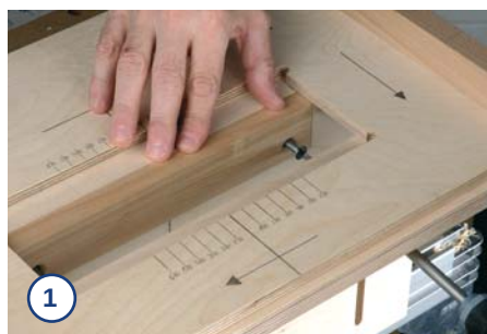
1. Der Zapfen wird ohne Ausreißholz gefräst. Beim Schlitzfräsen muss er aber unbedingt vorher angeschraubt werden.
