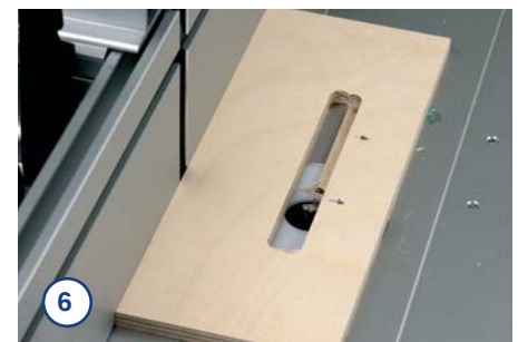
6. Danach erweitern Sie den Schlitz (wie im Foto zu sehen) von 10 mm genau auf 17 mm, so dass die Kopierhülse spielfrei hin- und herläuft.
