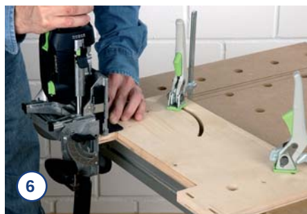
6. Fräsen Sie 5 x 30 mm Dominos senkrecht in die Frontplatte. Damit die Fräse nicht kippt, schrauben Sie den Kunststoffwinkel an.
