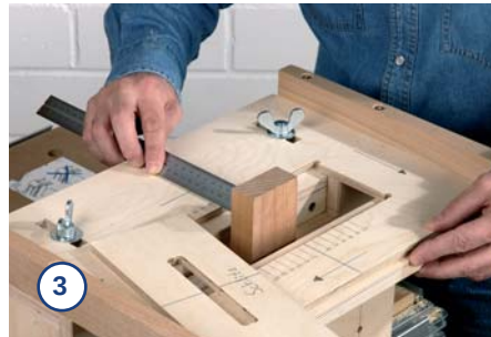
3. Spannen Sie das Werkstück ein und richten Sie den Schablonenträger ...
