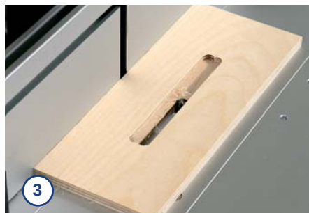
3. ... anbringen!) und danach auch von der Rückseite bearbeiten. Achten Sie darauf, gegen die Laufrichtung des Fräasers zu arbeiten.
