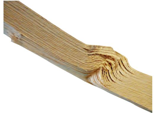
*Der hydraulische Druck, der beim Biegen in wassersatten Zellen entsteht, führt zu Faltenbrüchen.*
