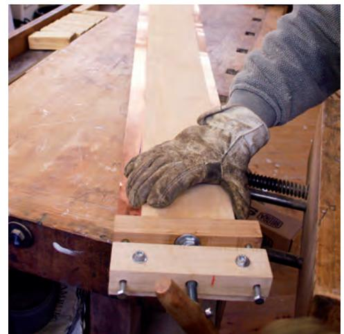
*Das erwärmte Holz wird so auf das Biegeband gelegt.*
