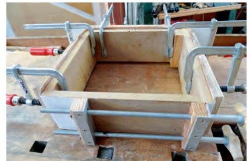
*Das Furnierpaket wird mit einem Spannband um den Formkörper gezogen, die Flächen zusätzlich mit Zwingen gepresst.*
