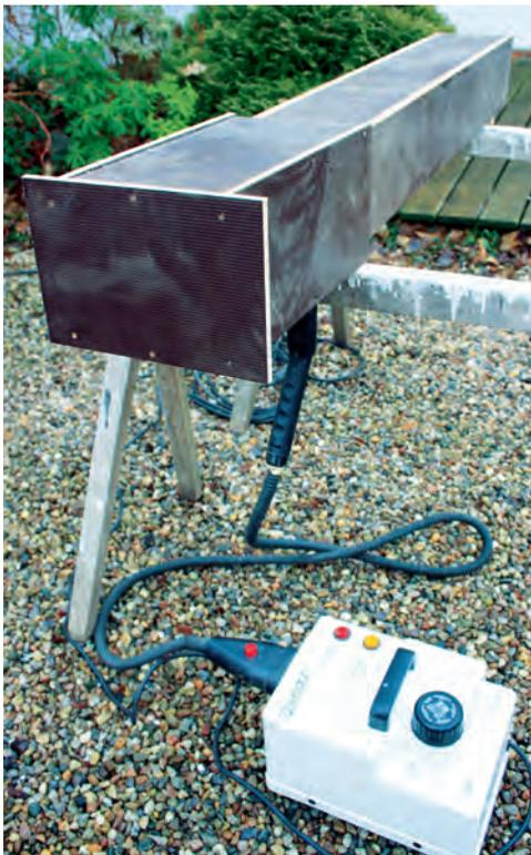
Eine Dämpfeinrichtung besteht aus einer Dämpfkammer und einem Dampfgenerator.
