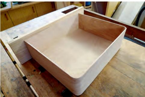
*Fertige Schublade mit angesetzter Front*
