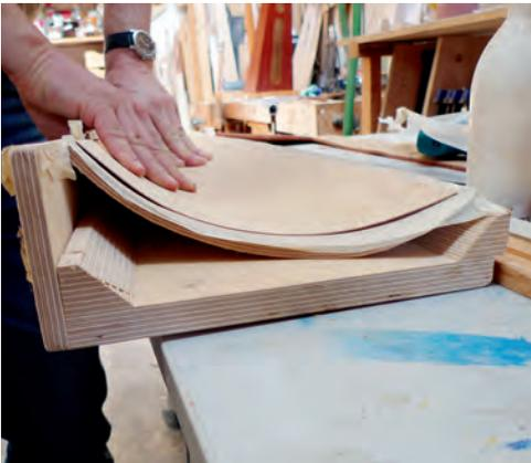
*Die Furnierlagen werden in eine Form eingelegt und mit Vakuum verpresst.*
