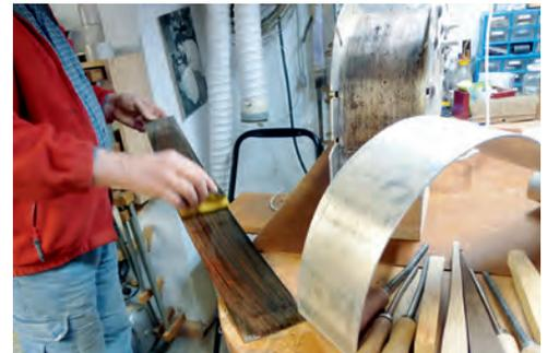
*Das Holz wird vor dem Biegen angefeuchtet, damit der entstehende Dampf die Biegung unterstützt.*
