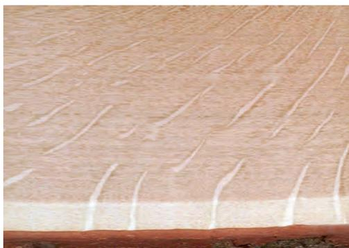
*Längsschnitt durch Eichenholz, als helle Streifen verlaufen die Markstrahlen vom Bast zum Kern.*
