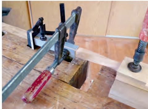
*Das gedämpfte Holz wird um seine Längsachse verdreht und bleibt eingespannt, bis es erkaltet ist.*
