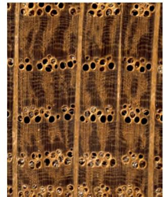
*Querschnitt durch Eichenholz, die großen Poren sind deutlich erkennbar und verlaufen im Bild waagrecht, entsprechend dem Verlauf der Jahresringe. Die senkrecht verlaufenden Linien sind die Markstrahlen.*
