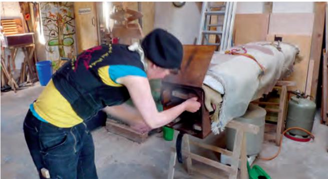
Eine einfache Dämpfeinrichtung besteht aus einer Kammer und einem gasbeheizten Kessel. Der Dampf wird über eine Rohrverbindung zwischen Kessel und Kammer zugeführt.
