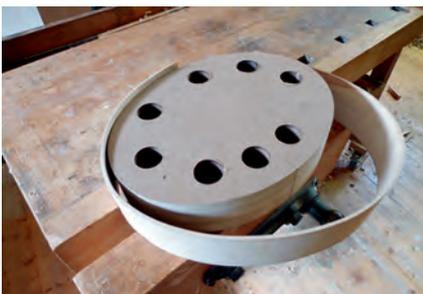
*Das geformte Holz federt um den Anteil der elastischen Biegung nach dem Entformen wieder auf.*
