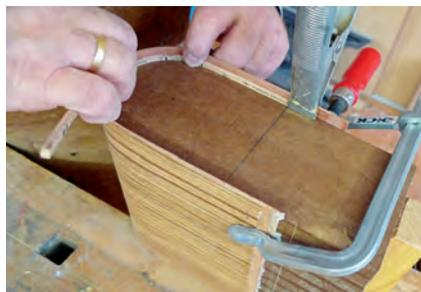
*Mit einem gebogenen Streifen „Bendywood“ wird die Leimkontaktfläche vergrößert.*
