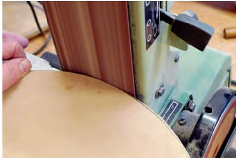
*Die Kontur wird mit einer Schleifmaschine dem Anriss angepasst.*
