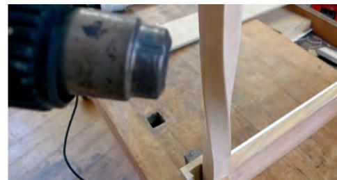
*Mit Heißluft wird das Tischbein erwärmt und durch Biegen von Hand gerichtet.*
