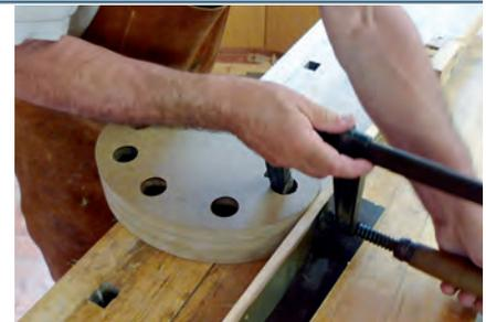
*Das Werkstück wird mit einer Schraubzwinde mittig an der Form befestigt.*
