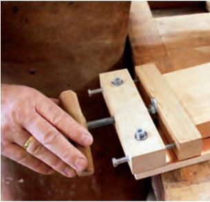
*Mit der Gewindespindel wird das Werkstück so eingespannt, dass es sich nicht längen kann. Die Versteifungsplatten an der Rückseite des Bandes verhindern ein Wegknicken des Bandes beim Einspannen.*
