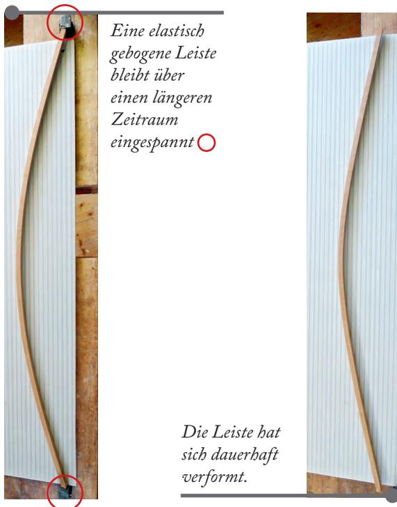
Holzfasern werden zerstört. Damit setzt der Bruch ein. Die Biegefestigkeit des Materials ist überschritten.
