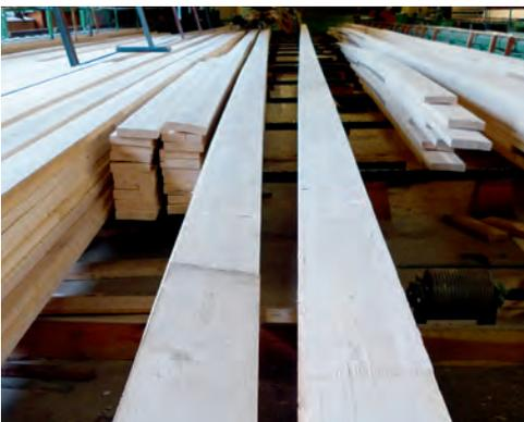
*Die Einzelbretter werden mittels Keilzinkenverbindungen zu beliebig langen Lamellen verklebt.*
