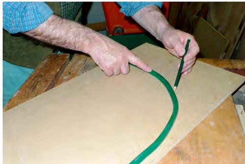
*Mit Hilfe eines biegbaren Kurvenlineals wird die Form aufgezeichnet.*
