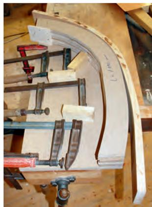
*Entfernt man die Spannmittel, federt das geformte Werkstück auf.*
