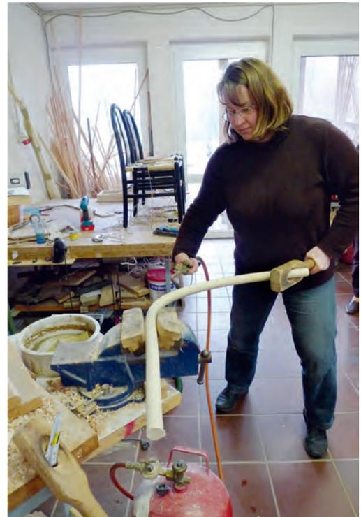
*Mit einer Flamme erwärmt, kann man Rattan leicht biegen.*
