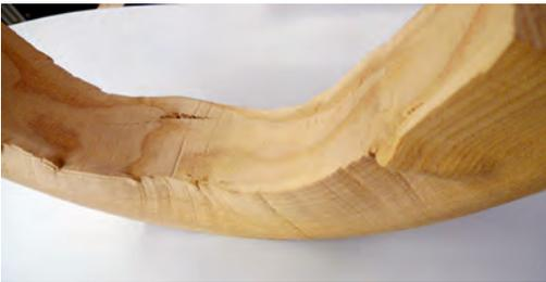
Bei extremer Biegung entstehen Verwerfungen an der druckbelasteten Seite.
