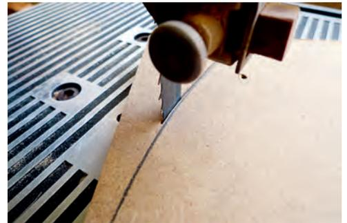
*Die Form wird ausgesägt. Dabei ist darauf zu achten, dass die Konturlinie nicht unterschritten wird.*
