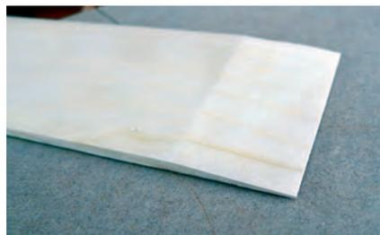
*Das Werkstückende ist abgeflacht, um eine Stoßkante im Ring zu vermeiden.*
