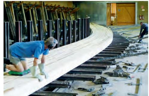
*Die mit Kleber benetzten Lamellen lassen sich leicht biegen. Sie werden als Schichtpaket in die Form gelegt.*
