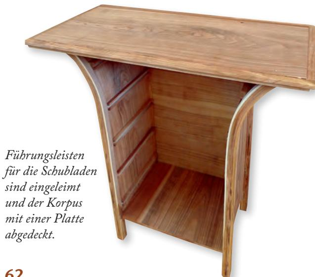
*Führungsleisten für die Schubladen sind eingeleimt und der Korpus mit einer Platte abgedeckt.*
