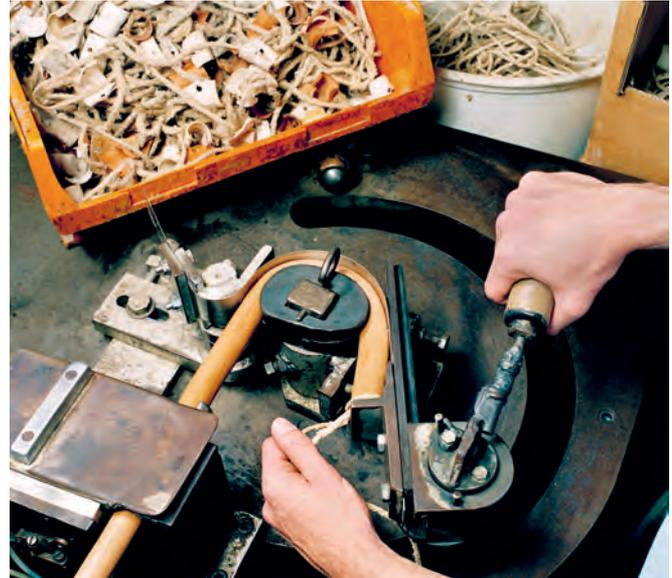
*Vorrichtung zum Formen von Stockgriffen mit naturbelassener Oberfläche. Das Stahlband verhindert ein Längen des Holzes während der Biegung. Mit dem Bindfaden wird das gebogene Werkstück fixiert.*
