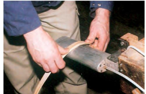
*Biegen der einzelnen Späne auf dem Biegeeisen*
