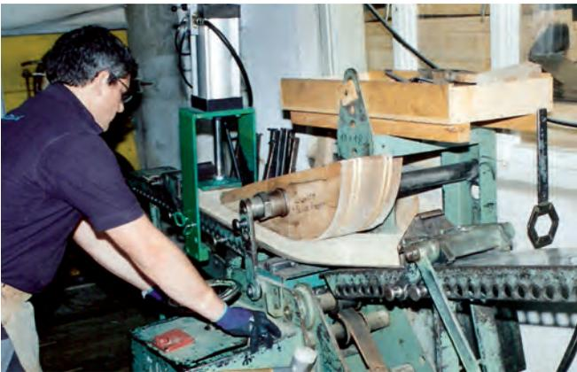
*Das Werkstück wird mit dem Biegeband so eingespannt und gebogen, dass keine Dehnung möglich ist.*
