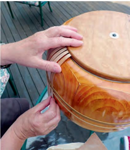
*Die auf die Form geschraubte Bodenplatte hat am Umfang eine Nut. Der gebogene Holzstreifen wird an einem Ende in der Nut, am anderen Ende mit einem Gummiband fixiert.*
