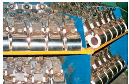
*Die eingespannten Rohlinge kühlen in einem Magazin ab.*
