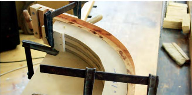
*Während des Formens werden weitere Schraubzwingen angesetzt und das Holz an die Form gepresst.*
