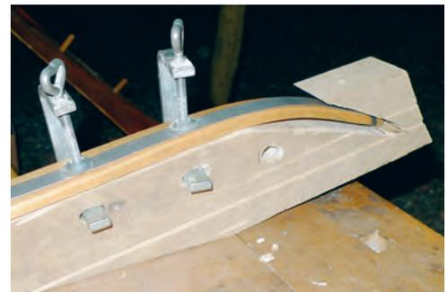
Danach wird das erweichte Holz um einen Körper geformt. Es bleibt auf der Form eingespannt, bis das Holz erkaltet ist.
