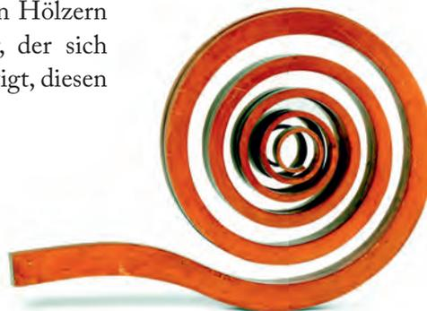
*Ein ca. 10 m langes Buchenkantholz wurde zu einer Spirale geformt. Gefertigt von der Fa. Thonet (Foto Thonet).*
