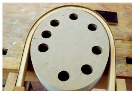
*Nach dem Erkalten federt das Werkstück etwas auf, sobald man die Fixierung entfernt.*
