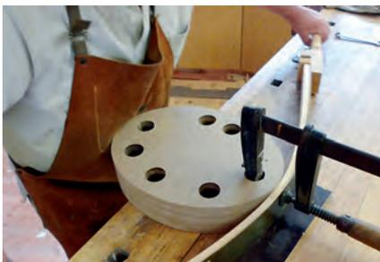
*Beide Werkstückenden werden mit gleichmäßiger Kraft um die Form gebogen.*
