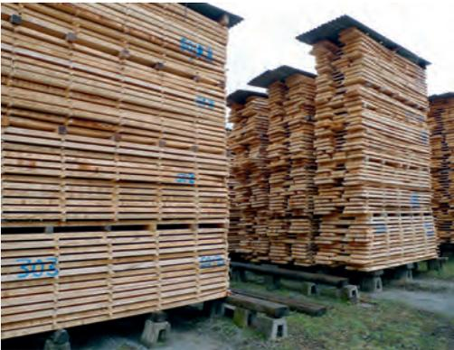
*Holz wird mit Abstandsleisten zum Trocknen aufgestapelt.*
