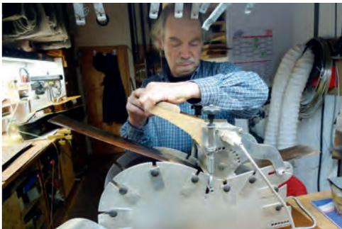
*Zuerst wird die Taille geformt.*
