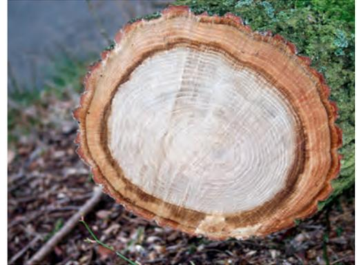
*Eichenholz, ein typisches Kernholz. Deutlich erkennbar der Unterschied von Kern- und Splintholz, bei dem frisch gefällten Baum ist das Splintholz mit Wasser gesättigt.*
