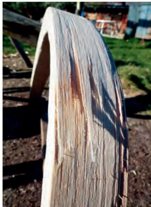
*Das Werkstück war nicht ausreichend fest mit dem Stahlband eingespannt, die Folge sind Risse an der Oberfläche.*
