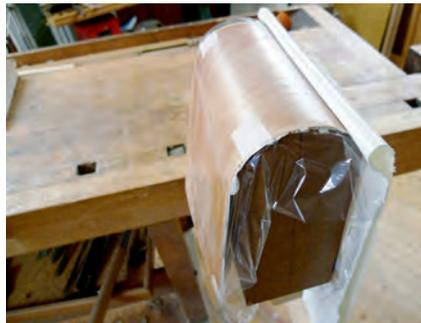
*Nach ca. 5 Stunden wird das Werkstück entformt.*
