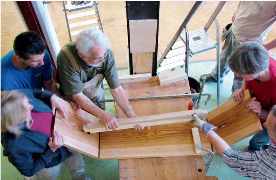
*Die Schenkel der Bank werden gebogen und mit einem Querriegel fixiert.*
