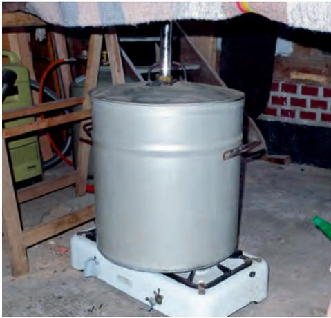
Ein beheizter Kessel, der durch ein Rohr mit der Dämpfkammer verbunden ist, wird zur Dampferzeugung benutzt.
