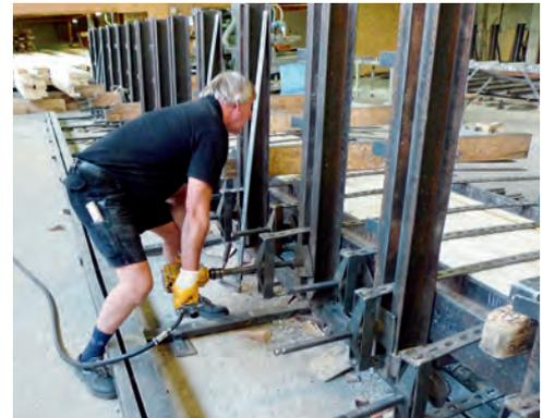
*Das Lamellenpaket wird verpresst. Mit Gewindespindeln wird die Presskraft aufgebracht.*
