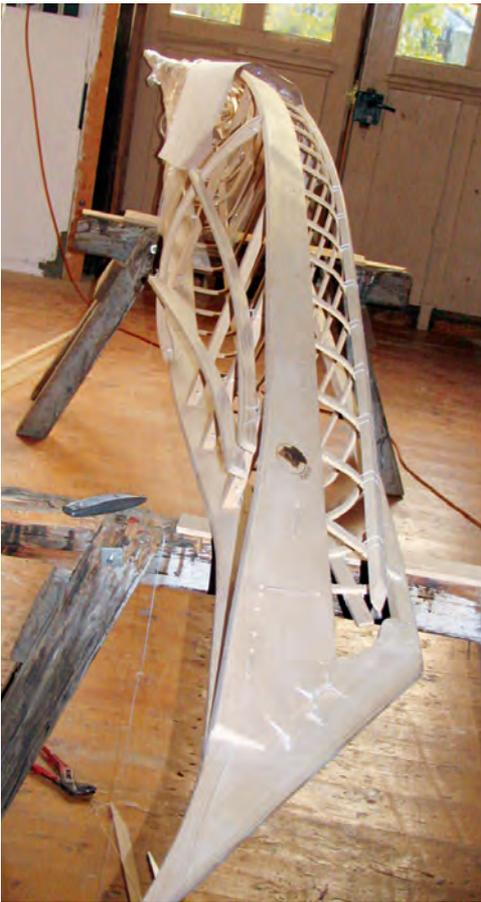
*Das Leistengerüst fertig zur Bespannung*
