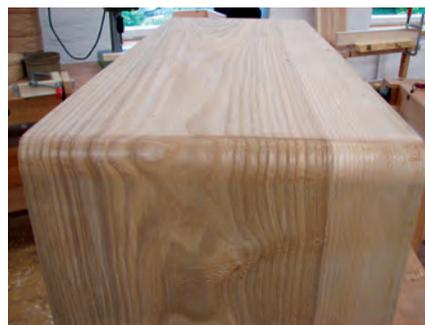
*Das Biegen mit einem Biegeband garantiert eine rissfreie Oberfläche.*
