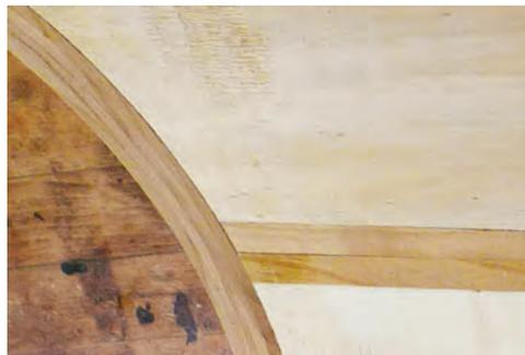
*Durch die seitlichen Umleimer werden die einzelnen Frontplatten zum Furnieren zusammengehalten.*
