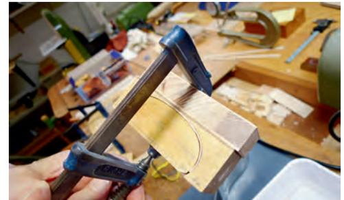
*Für das Formen des konkaven Mittelbügels wird eine separate Form verwendet.*
