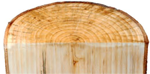
*Beim Lindenholz besteht kein farblicher Unterschied zwischen verkernntem Reif- und Splintholz.*
