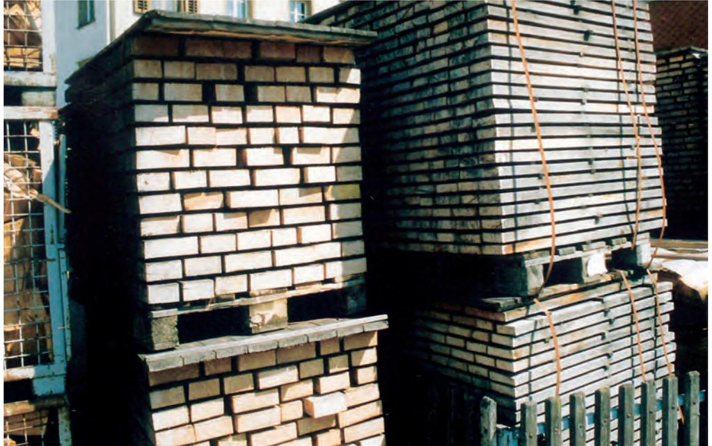
Wichtig für die Qualität ist auch die Trocknung. Das gespaltene Holz wird gestapelt und 3 Jahre luftgetrocknet, bevor es verarbeitet wird.
