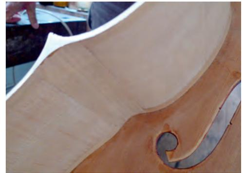
*Innenansicht eines Cellos: Leimflächenvergrößerung erfolgt durch Holzstreifen und die Verbindung der einzelnen Zargenstücke untereinander durch angepasste Klötzchen.*
