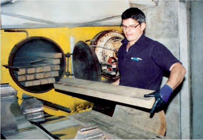
*Das gedämpfte Holz wird der Dämpfretorte entnommen.*
