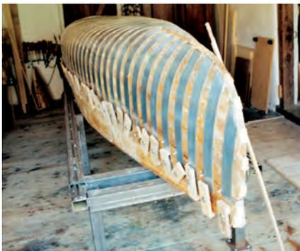
Form für einen Kanadier. Deutlich erkennbar die Metallstreifen, die als Amboss dienen, und die Klemmhebel, mit denen die gebogenen Spanten fixiert werden.
