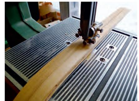
*Das gebogene Werkstück wird getrennt, so entstehen zwei gleiche Holme.*
