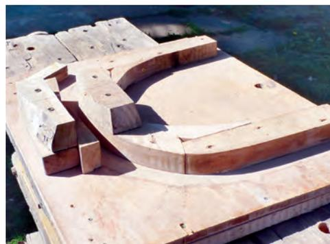
*Biegeform aus Holz. In der Mitte wird das Werkstück mit Keilen gegen die Form gepresst.*
