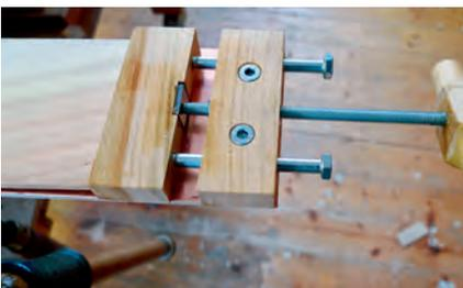
*Am anderen Ende des Biegebandes befindet sich eine Spanneinrichtung.*
