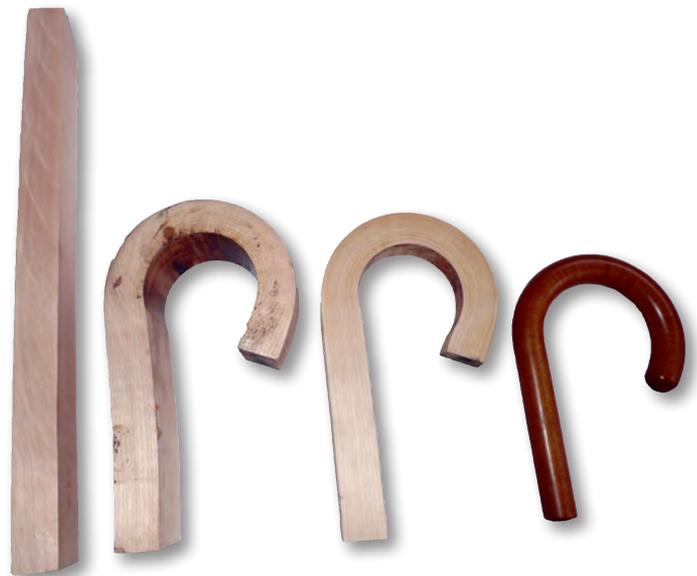
*Die einzelnen Fertigungsstufen vom geraden Kantholz zum fertig polierten Schirmgriff*
