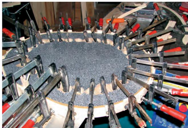
*Die Einstiegs Luke des Bootes wird aus zwei dünnen Leisten schichtverleimt. Dazu werden die gedämpften Hölzer um einen Formkörper (im Bild grau) gebogen und verleimt. Mit einer Vielzahl von Schraubzwingen wird die Pressung erzeugt.*
