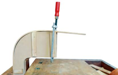
*Das gebogene Holz wird fixiert, bis es abgekühlt ist. Ungleiche Erwärmung während des Biegens führt zu Abweichungen von der Biegeform, deutlich als Spalt erkennbar.*
