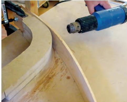
*Mit einer Heißluftpistole wird das Werkstück erwärmt und gleichzeitig gebogen.*
