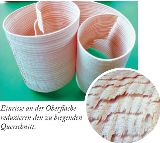
*Einrisse an der Oberfläche reduzieren den zu biegenden Querschnitt.*
