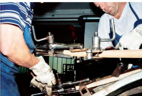
*Biegeband mit Einspannmöglichkeit. Deutlich erkennbar sind die Gewindespindeln, mit denen das Holz eingespannt wird, um eine Dehnung an der Außenkrümmung zu vermeiden.*
