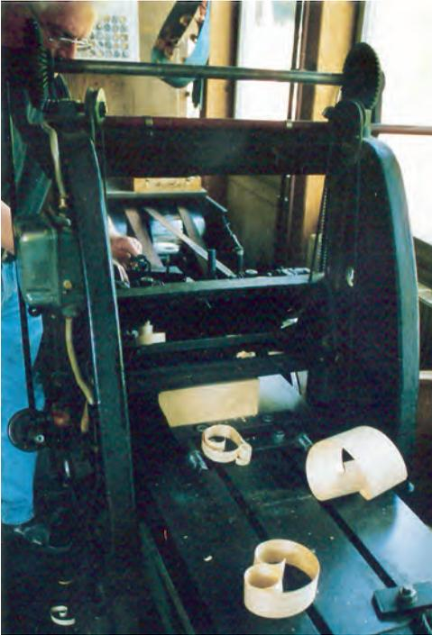
*Gleichmäßige Späne werden Lage für Lage abgehobelt und auf unterschiedliche Breiten geschnitten.*
