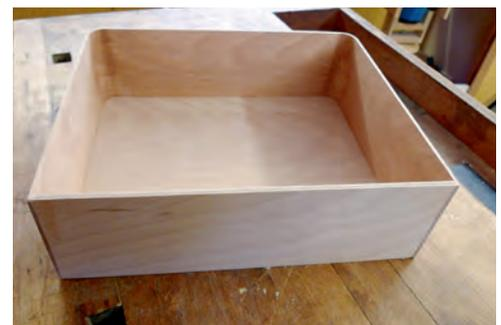
*Boden und Front aus Sperrholz sind mit dem Formteil verleimt.*
