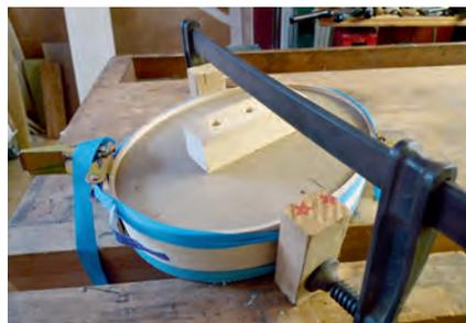
*Die überlappenden Enden des Werkstückes werden verleimt.*
