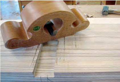
*Der rechteckige Teil des Profils wird mit einem Grundhobel ausgearbeitet.*
