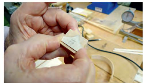
*Nach der Schablone wird das Klötzchen aus Fichtenholz angerissen und ausgestoßen.*
