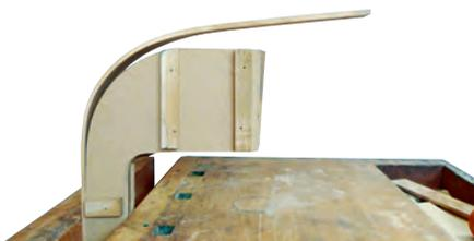
*Nach dem Erkalten federt das Werkstück um den Anteil der elastischen Biegung auf.*
