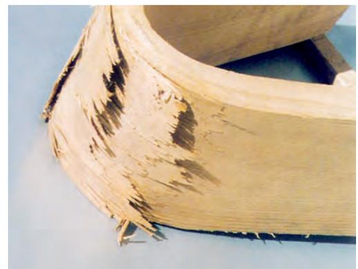
*Wird die Festigkeit der Holzfasern überschritten, entstehen Risse an der Oberfläche.*
