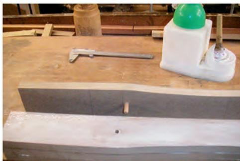
*Mehrere Platten werden zu einer Form verleimt. Dübel positionieren die Platten zueinander.*
