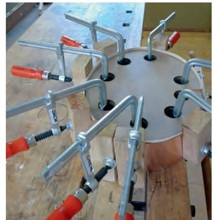
*Mit zusätzlichen Schraubzwingen wird das Werkstück solange fixiert, bis das Holz abgekühlt ist.*
