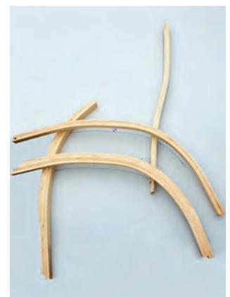
*Eine Zeichnung im Maßstab 1:1 hilft, die Proportionen des Entwurfes zu beurteilen und die geformten Werkstückrohlinge zu überprüfen.*
