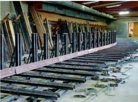
*Die Biegeform besteht aus einzelnen Winkeln, die entsprechend dem Biegeradius auf im Hallenboden eingelassenen Schienen verschraubt sind.*
