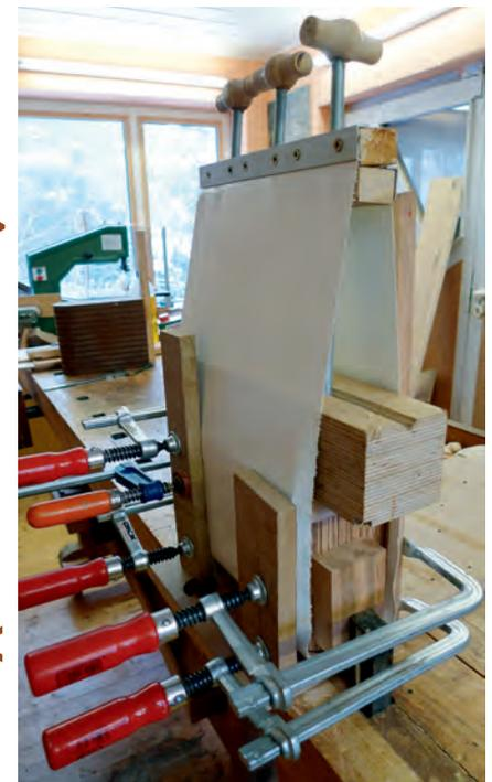
*Formholz und Seitenwand werden mit dem Spannband verpresst und verleimt.*
