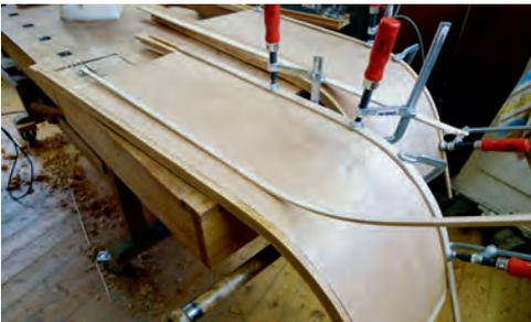
*Mit einer Lamelle wird der Falz abgedeckt.*
