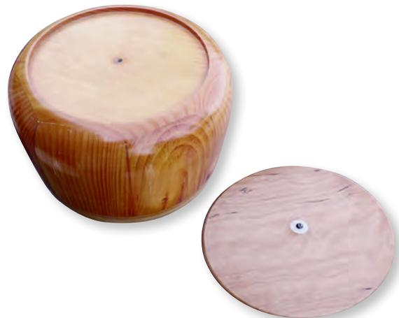
*Form und Bodenplatte für einen runden Korb. Die Bodenplatte wird auf die Form geschraubt. Die Form ist aus Segmenten so verleimt, dass senkrechte Markierungen entstehen, an denen die Holzstreifen ausgerichtet werden.*
