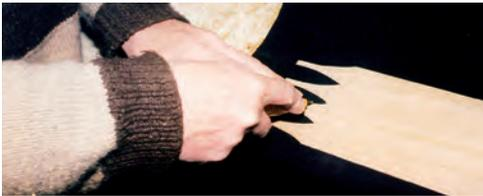
*Mit einem Messer wird eine Fasse an die „Finger“ geschnitten.*
