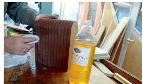
Die Oberfläche der Form wird mit Leinöl abgesperrt.
