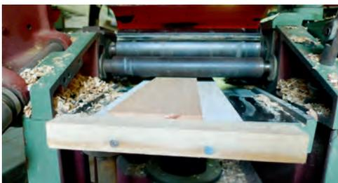
Die Schichthölzer werden mit einer konischen Auflage durch die Dicke geschickt.
