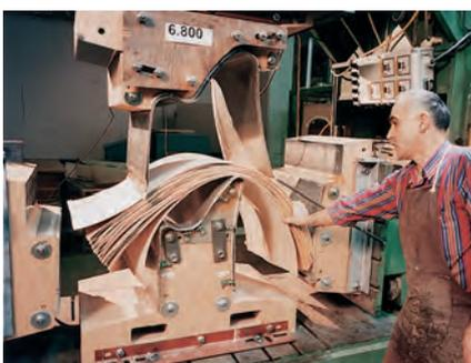
*Das Presswerkzeug wird geschlossen.*
