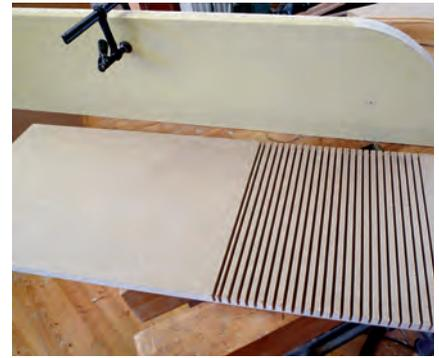
Die Biegeform wird aus zwei geformten Platten und einer geschlitzten MDF-Platte erstellt.
