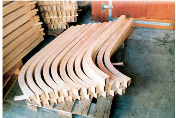
*Die Rohlinge lagern aufgestapelt bis zur Fertigbearbeitung.*
