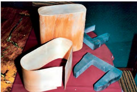
*Ein einfacher Holzkörper dient als Biegeform, um ihn wird der Span gebogen.*
