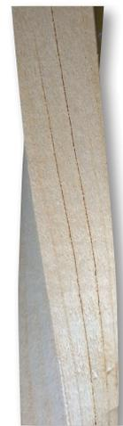
*Beim Verdrehen entstehen Scherkräfte im Holz, die an der Oberfläche, in Faserrichtung, feine Risse hervorrufen können.*
