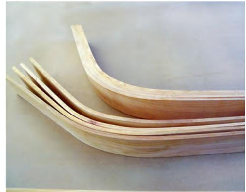
*Die Abbildung zeigt die geformten Einzel-lamellen und den verleimten Biegerohling.*
