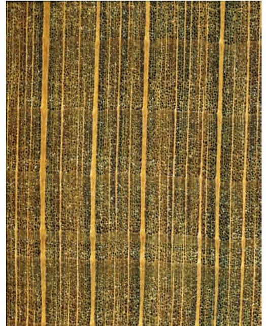
*Querschnitt durch Buchenholz, ein typisches zerstreuporiges Holz (unterschiedliche Vergrößerung): Waagrecht verlaufen die Jahresringe.*
