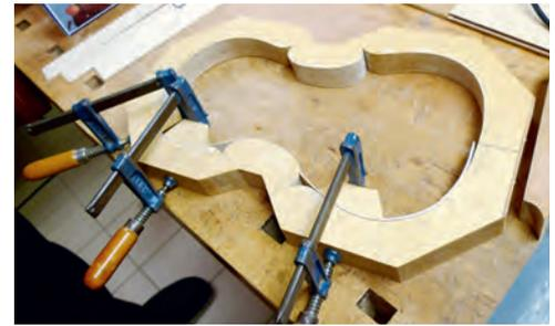
*Außenform zur Zargenherstellung. Mit Druckstücken werden die Zargensegmente gegen die Form gepresst.*
