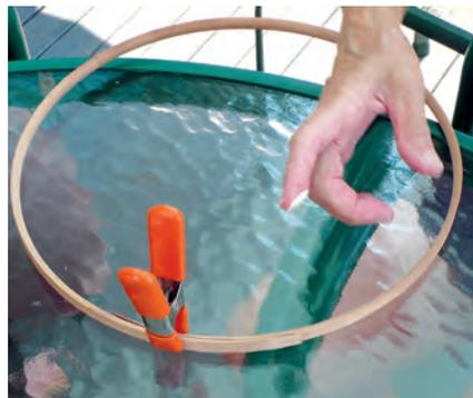
*Der innere Reifen wird im Durchmesser angepasst und zu einem geschlossenen Ring verleimt.*
