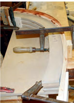
*Das geformte Werkstück wird fixiert, bis es erkaltet ist.*
