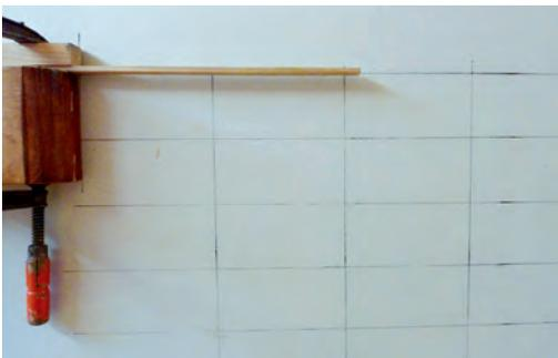
Bei Entlastung federt die Leiste in die Ausgangslage zurück.
