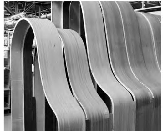
*Die gebogenen Rohlinge werden ca. 6 Monate gelagert, um alle internen Spannungen abzubauen, bevor sie weiter bearbeitet werden.*
