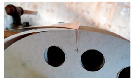
*Das abgeflachte Ende des Werkstückes wird unter das Biegeband geschoben, und mit der Gewindespindel wird das Werkstück so eingespannt, dass es sich nicht dehnen kann.*
