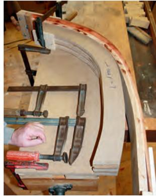
*An einem Ende wird das Werkstück mit einer Schraubzwinde an der Form befestigt, das andere Ende wird gebogen.*
