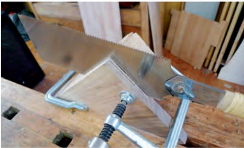
*In Faserrichtung wird die Ecke des Brettes eingesägt.*
