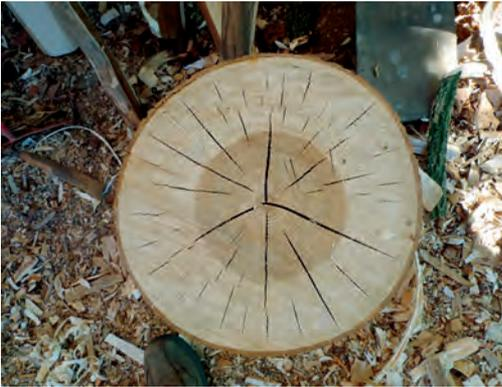
*Trocknungsrisse in einem gefällten Stamm*
