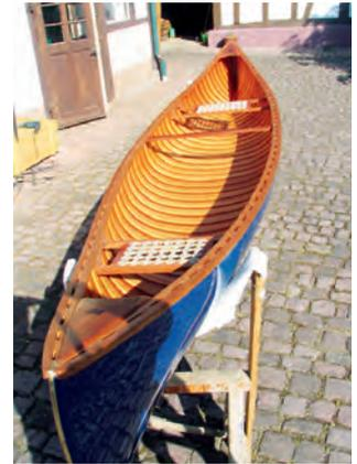
Der fertige Kanadier mit Spantengerüst
