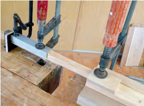
*Das Werkstück wird in der Hobelbank eingespannt. Nur der zu verdrehende Bereich ist frei.*
