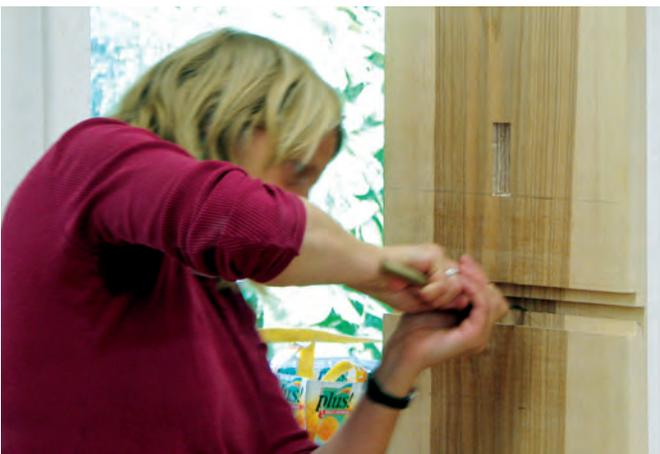
*Mit einem gebogenen Messer wird die Nutform erzeugt.*
