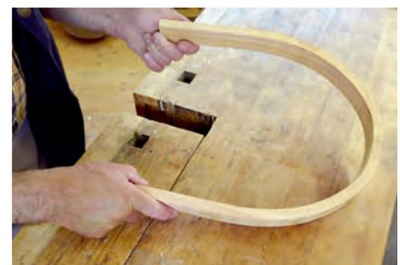
*Das Holz wurde dauerhaft zu einem U-förmigen Körper geformt.*
