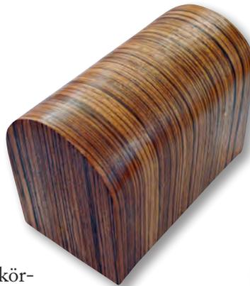
Der halbrunde Deckel der abgebildeten Schatulle wurde aus Buchenfurnier schichtverleimt und mit einem Deckfurnier aus Zebrano-Holz versehen (Zeichnung: Abmaße des Deckels).
