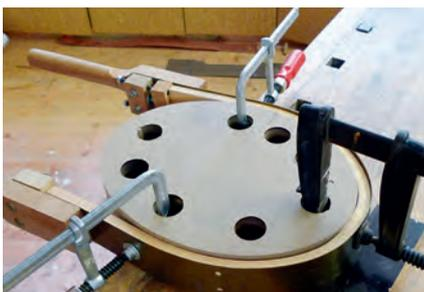
*Das geformte Holz wird mit Zwingen in seiner Lage fixiert, bis es erkaltet ist.*
