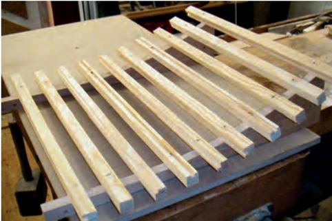
Leisten auf Formstücke geleimt bilden die Biegeform für das Verleimen geschlitzter MDF-Platten.
