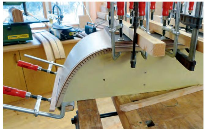
Furnier und Sperrholz werden verpresst, die Fläche außerhalb der Krümmung wird zusätzlich mit einer Platte gepresst.
