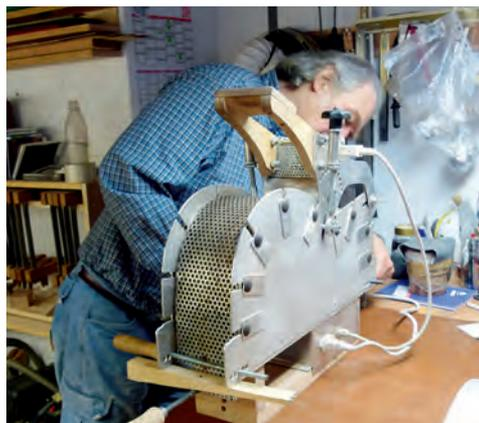
*Das Holz wird gegen die Form gepresst und bleibt so eingespannt.*
