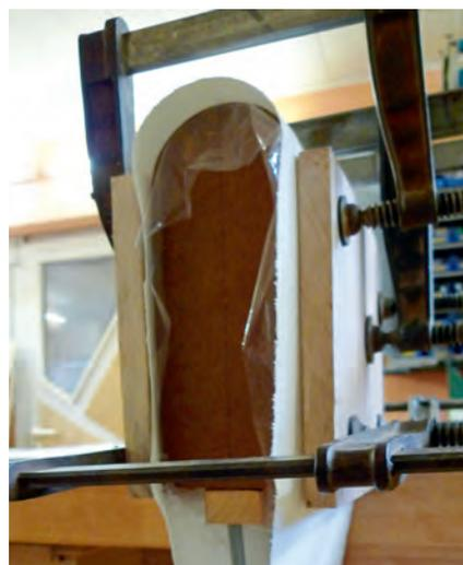
Die Furniere werden mit dem Spannband gegen die Form verpresst, zusätzlich werden die seitlichen Flächen mit Zwingen angepresst.
