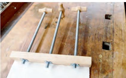
Spannband mit Gewindespindeln
