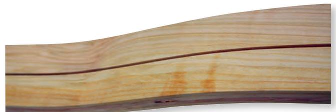
*Symmetrische Formteile werden in einem Stück geformt und dann aufgeschnitten. So wird ein gleichmäßiges Rückfedern sichergestellt.*
