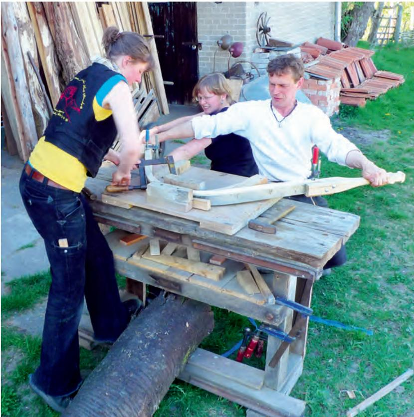
*Das Formen der Stuhllehne ist ein Kraftakt. Das im Stahlband eingespannte Holz wird um eine Holzform gebogen.*
