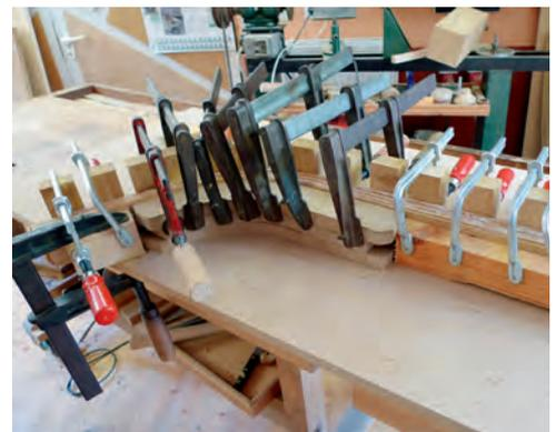
*Die belemmten Bretter werden auf der Biegeform gepresst.*
