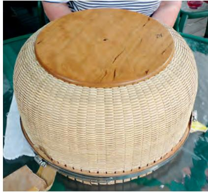
*Der beleimte, noch offene Außenring wird mit einem Spannband verpresst, sodass eine feste Leimverbindung zwischen Innenring, Holzstreifen und Außenring entsteht.*
