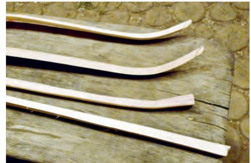
„Gekochtes Holz“ wird vorzugsweise bei der Formung der Enden eines Bogens verwendet.
