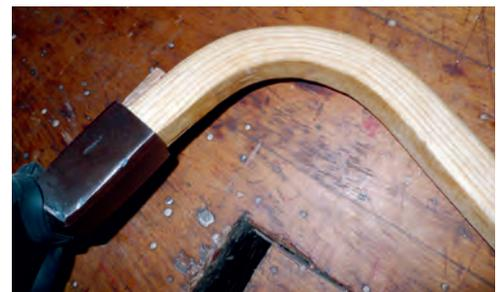
*Stiel eines Dechselfs, gebogen aus 25-mm-Eschenholz. Gut erkennbar ist der Faserverlauf.*
