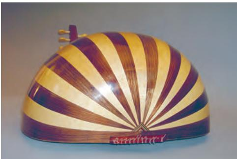
*Bei der abgebildeten Laute sind die Spanenden mit einem dreieckigen Holz eingefasst, eine Alternative zur Außenkappe, gefertigt von Matthias Wagner.*
