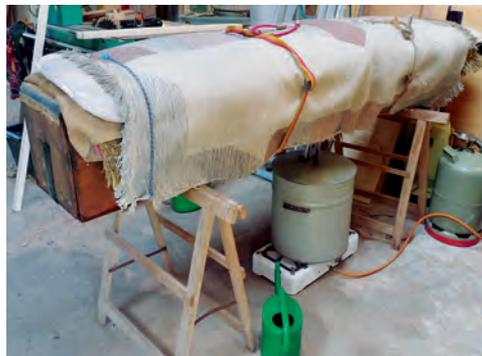
*Dämpfkiste mit zugehöriger Dampferzeugung. In einem Kessel wird Wasser gekocht und der Dampf über ein Rohr in die Dämpfkiste geleitet.*
