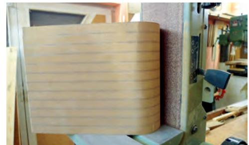
Der Formkörper, um den das Furnier gebogen wird, besteht aus verleimten MDF-Platten. Die Kontur wird ausgesägt und die Oberfläche geschliffen.
