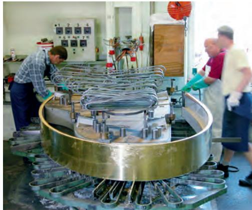
*Die einzelnen Holzlagen werden mit Leim beaufschlagt, in ein Metallband eingebunden und um eine Form gebogen.*
