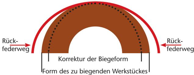
*Der Radius der Biegeform wird um den Rückfederweg verkleinert, um die gewünschte Form des zu biegenden Werkstückes zu erhalten.*
