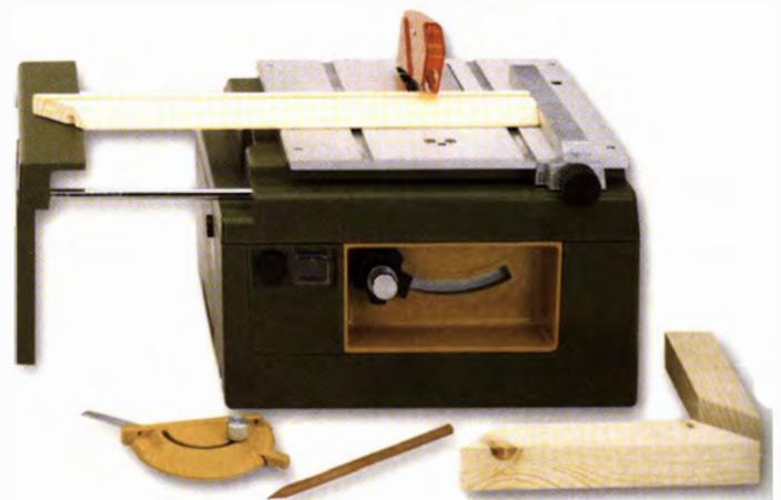
Kanten sind möglich. Allerdings ist die Stärke des Materials auf etwa 22 mm beschränkt. Mit der Bandsäge können Sie gekrümmte Schnitte in Material bis zu einer Stärke von 80 mm ausführen. Abricht- und Dickenhobelmaschinen lassen die Bearbeitung von Material bis zu 80 x 40 mm zu.
