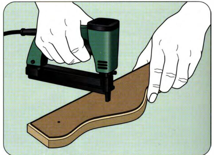
**2** Es gibt verschiedene Methoden, die Schablone am Werkstück zu befestigen: Falls die Schablone auf der Oberseite des Werkstücks befestigt werden soll, kann sie mit Drahtstiften oder Schrauben provisorisch angebracht werden. Die Verbindungsmittel sollten in einiger Entfernung von der Schablonenkante angebracht werden, damit sie nicht mit dem Fräser in Berührung kommen. Außerdem sollte man sie so setzen, dass die Löcher im fertigen Werkstück nicht zu sehen sind.
