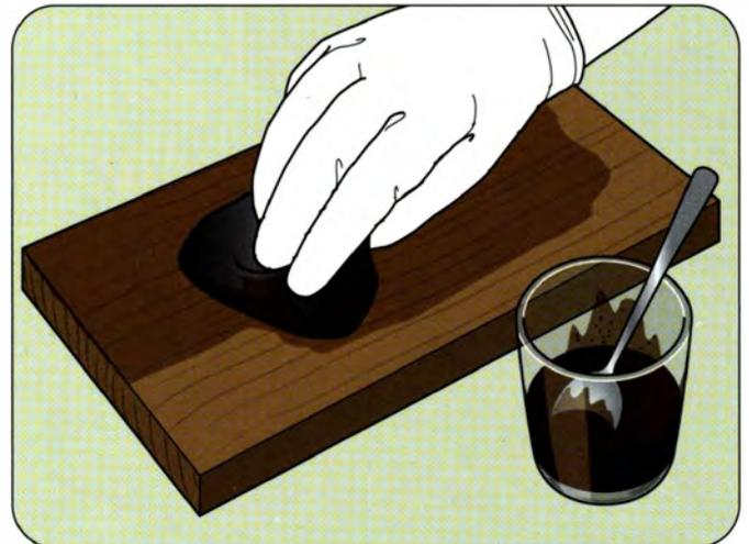
**3** Prüfen Sie die Beize auf einem Stück Restholz. Um sie dunkler zu machen, fügen Sie Pigment hinzu. Um sie aufzuhellen, werden gleiche Teile Öl und Terpentinöl hinzugefügt.
