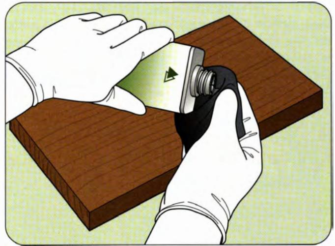
**2** Tragen Sie Schutzhandschuhe, und halten Sie den Ballen an die Öffnung der Schleifgrundflasche. Drehen Sie die Flasche vorsichtig, um eine kleine Menge des Schleifgrundes auf den Ballen zu bringen.
