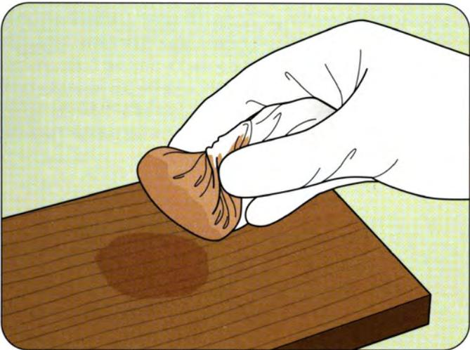
**5** Drehen Sie die Hülle wieder zusammen, und erproben Sie den Ballen auf einem Stück Restholz. Geben Sie die Politur nicht von außen direkt auf die Hülle, da diese als Filter dient.
