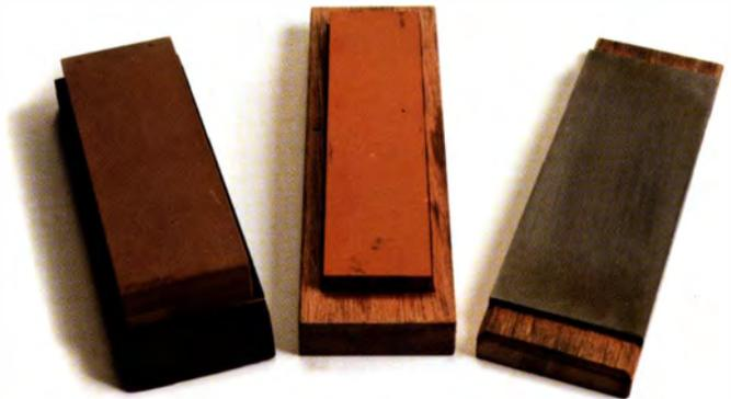
▲ **Schleifsteine** Mit Öl-, Wasser- und Diamantschleifsteinen werden Hobeleisen und Stechbeitel geschärft und abgezogen.
