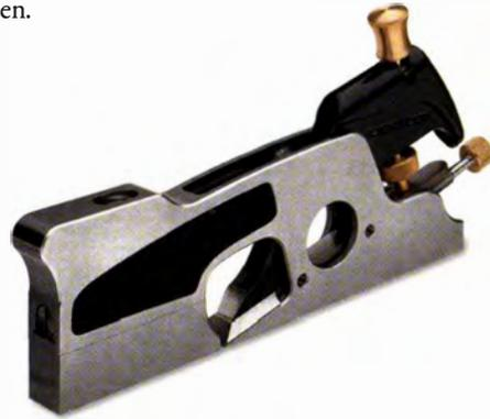
Der Falzhobel hat einen verstellbaren Seitenanschlag, man kann mit ihm saubere, genaue Fälze aushobeln. Obwohl er weitgehend von der Handoberfräse verdrängt worden ist, ist es oft schneller – und auf jeden Fall sauberer – einen Simshobel für eine kleine Arbeit zu verwenden, als extra die elektrische Handoberfräse einzurichten.
