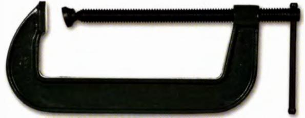
▲ **Zwingen** Mit Zwingen kann man Werkstücke an der Hobelbank befestigen. Sie werden auch bei der Montage und dem Verleimen benötigt. Schnellspannzwingen sind vielseitig und bieten ein gutes Preis-Leistungsverhältnis, während die traditionellen Schraubzwingen belastbarer sind.
