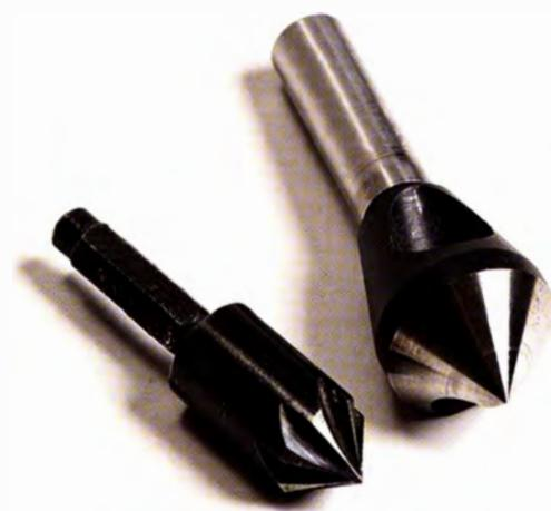
Um den Winkel an der Unterseite der Schraube zu reproduzieren, kann man einen Versenker mit einem Winkel von 90° verwenden, es gibt jedoch auch Versenker mit einem Winkel von 60°. Die Schneiden eines Versenkers können entweder gerade oder in Spiralförmigkeit verlaufen, letzteres ergibt eine glattere Wandung. Es gibt auch Versenker, die sich mit einer kleinen Schraube an einem Spiralbohrer befestigen lassen.
