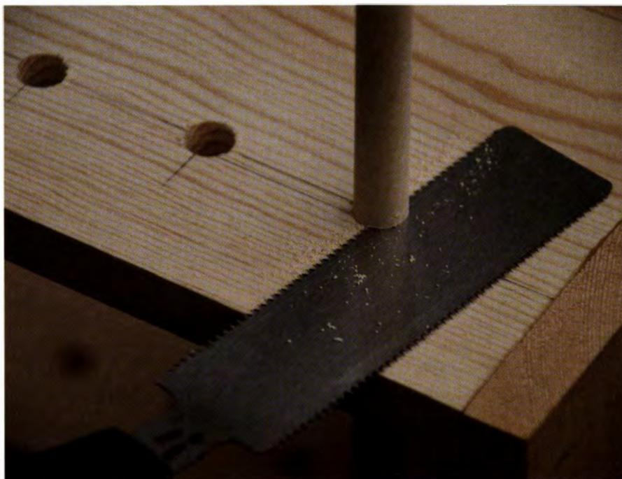
Mit einer einseitig geschränkten Säge können Dübel bündig abgesägt werden.
