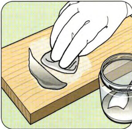
**3** Geben Sie die Mischung mit einem Tuch quer zur Faser an das Holz. Wenn die Oberfläche beginnt, sich trocken anzufühlen, nehmen Sie überschüssige Paste mit einem sauberen, feuchten Tuch ab, und lassen Sie die Oberfläche dann über Nacht trocknen.
