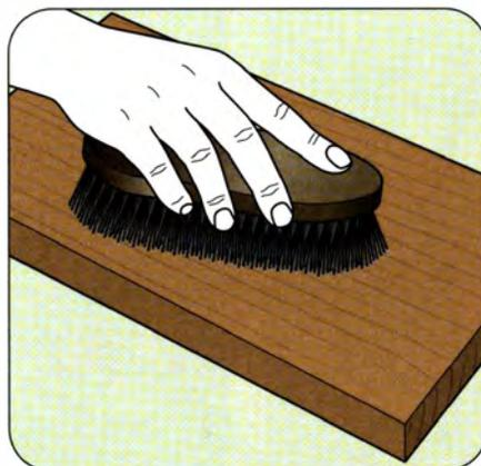
**3** Lassen Sie das Wachs antrocknen – das ist meist nach einigen Minuten der Fall, aber Sie sollten für den richtigen Zeitraum die Anweisungen des Herstellers zu Rate ziehen –, und polieren Sie dann die Oberfläche mit einer Bürste oder einem sauberen, weichen Lappen, bis sie glänzt.
