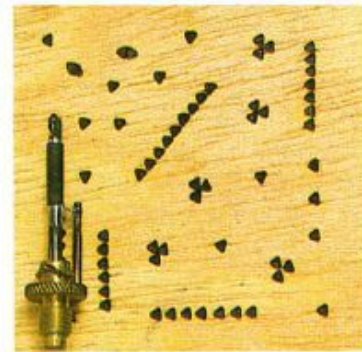
Punta de triángulo: Interesante para efectos muy concretos, graba pequeños y definidos triángulos equiláteros.
