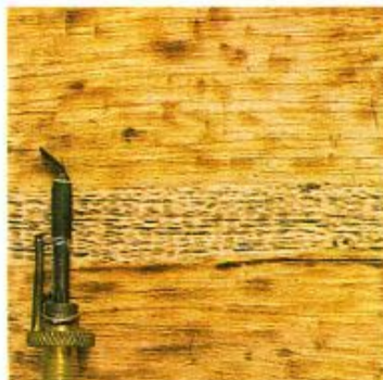
Punta de sombras: Utilizada para sombrear fondos, debe calentarse lentamente y a escasa temperatura. Permite obtener modelados ligeros.
