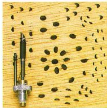
Punta oval: A pesar de que su trazo resulta oval, se puede modificar el efecto variando la forma en que se incide.
