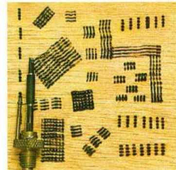
Punta de tenedor: según la posición con que se utilice permite obtener cuatro puntos nítidos o cuatro líneas paralelas.
