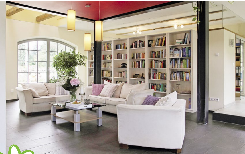
Die Stahlstützen, die das Obergeschoss abfangen, sind ein spannendes Element im Wohnzimmer.
