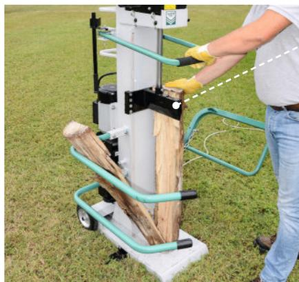
**Le coin ne remonte pas automatiquement**: dans ce cas, il faut appuyer sur la commande de remontée, jusqu'à la hauteur voulue et commencer à fendre une autre bûche ou celle déjà fendue en deux pour en faire quatre morceaux par exemple. Mettez la partie arrondie de l'une des moitiés de bûche vers le mât et actionnez le vérin. Recommencez l'opération autant de fois souhaitée.
