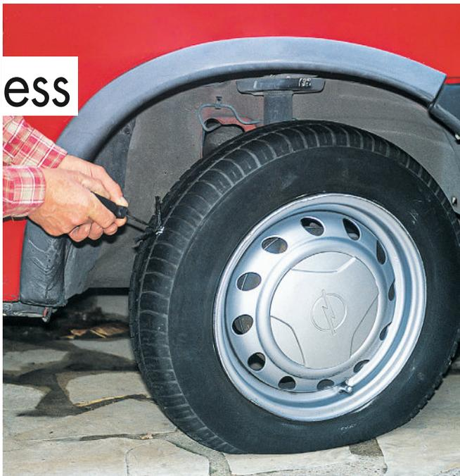
le trou et, ainsi, à le colmater. Selon les kits, les mèches sont fournies préencollées ou à enduire soi-même de colle-dilution spéciale conditionnée en tube.
