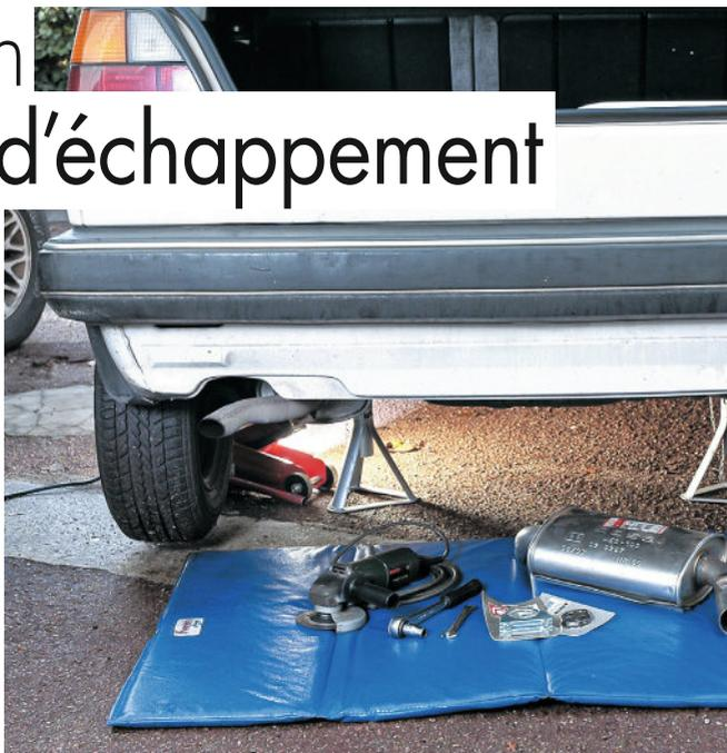
pas assez chaud. Si, en plus, la voiture reste longtemps à l'arrêt, l'humidité de l'air pénètre dans l'échappement et s'y condense, favorisant la corrosion.
