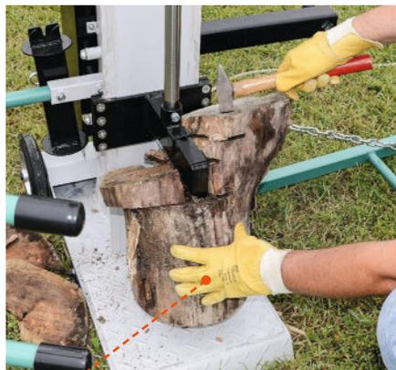
**Le bois humide et/ou avec des nœuds peut être difficile à couper**. Il risque de vriller ou de bloquer le coin à fendre. Pour éviter cela, positionnez les nœuds en partie haute. Si le coin reste coincé, utilisez une barre à mine, une petite masse ou un marteau. Il peut arriver aussi que des fibres restent accrochées, empêchant la séparation des morceaux. Utilisez une hachette pour finir le travail.
