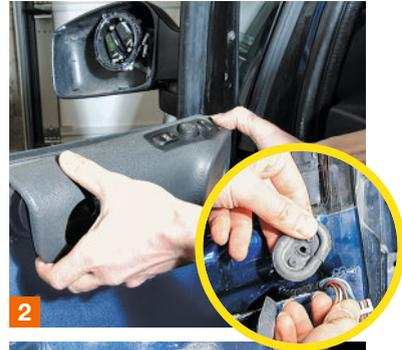
**2.** Déclipsez le cache de la portière en prenant garde de ne pas endommager les conducteurs des commandes, notamment en retirant le joint en caoutchouc du passe-fils.
