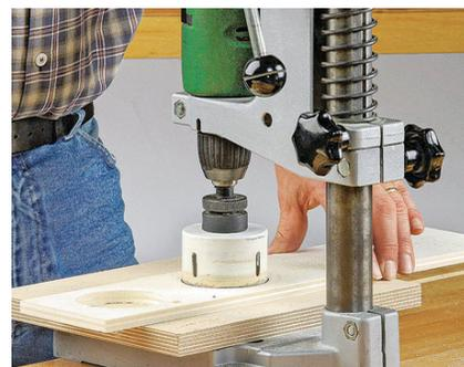
**1** Maintenez la planche d'une main et de l'autre pointez doucement le foret de la scie cloche sur le centre du trou. Abaissez le levier du support de perceuse pour réaliser la découpe. Répétez l'opération pour les autres trous.
