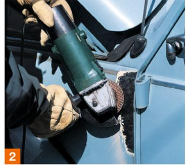
**2.** Passez la surface corrodée au disque à ébarber, légèrement incliné. Meulez superficiellement en adoucissant les bords de la zone découpée.
