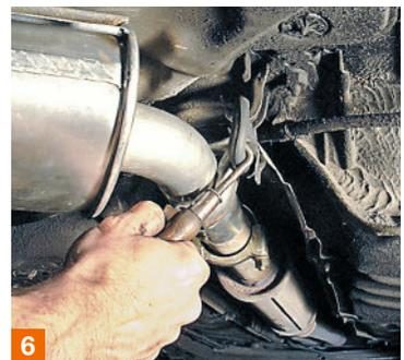
**5.** Il est moins risqué d'entailler le manchon à la disqueuse en veillant à ne pas entamer le tube logé dedans. Enfoncez un vieux tournevis dans l'entaille et faites tourner le manchon sur lui-même.
