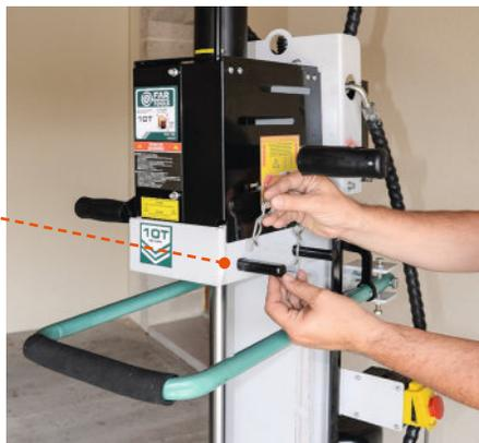
**Les bras de retenue latérale** sont des éléments importants de sécurité qui doivent être montés sans faute. Ils se glissent dans des tubes soudés sur le mât puis sont boulonnés. Ils retiennent les bûches afin qu'elles ne chutent pas trop loin, lors de l'éclatement du bois.
