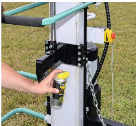
**Graissez le rail de guidage du coin**, après chaque utilisation. Il existe des produits en bombe, spécialement conçus pour cet usage. Nettoyez quand même le guide avant l'application, pour retirer les poussières et les éclats.
