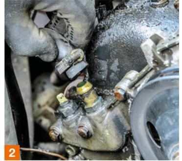
**2.** Débranchez la sonde de température d'eau, puis desserrez les colliers des durites : deux petites et deux grosses raccordées au radiateur du moteur.
