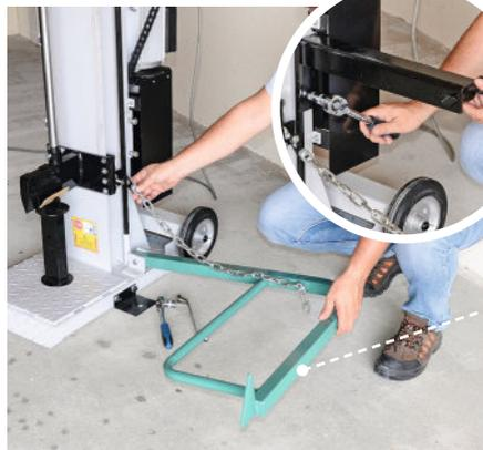
**Un bras de levage équipe cette machine,** pour faciliter la mise en place des bûches lourdes et de grandes tailles. Il se boulonne à la base du mât et la chaîne qui sert au levage se fixe sur le coin. Le bras se lève en même temps que le coin. Le bras est verrouillé en position haute sur un taquet vissé sur le mât.
