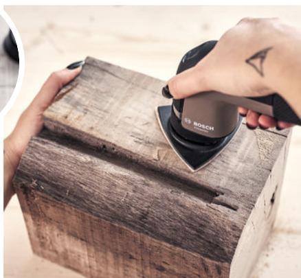
**5** Poncez les surfaces avec une petite ponceuse triangulaire. Dégrossissez avec un papier abrasif grain moyen (80). Finalisez avec un grain 120 pour une finition "lisse" ou 100 pour une finition "brute".
