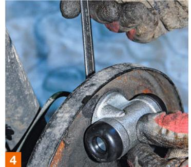
**3.** À l'aide d'une pince, décrochez le câble du frein avec précaution afin de désolidariser les garnitures à remplacer.
