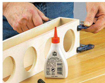
**2** Sur une surface plane, encollez et assemblez les éléments en les positionnant sur leur chant. Placez un premier serre-joint sur l'un des angles et un second à l'opposé puis les deux autres. Bridez l'ensemble, sans exagérer.
