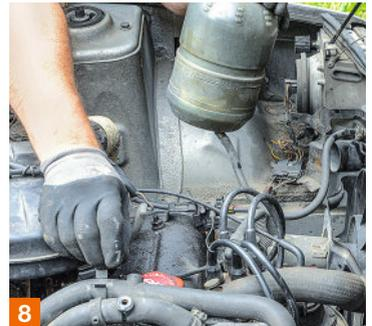
**8.** Retirez la vis de purge du circuit de refroidissement et démarrez le moteur. Si le vase d'expansion peut être déplacé, soulevez-le pour faciliter l'évacuation de l'air contenu dans le circuit.
