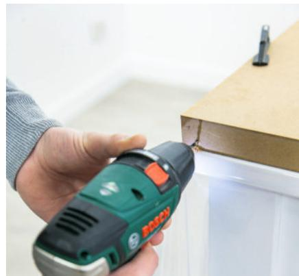
**3** Positionnez le pied contre le plateau puis repérez sur les chants les points de fixation avec un crayon. Prépercez le bois (Ø 1 mm) pour qu'il n'éclate pas lors du vissage des points de fixation. Répétez l'opération (étape 2) pour chaque pied.
