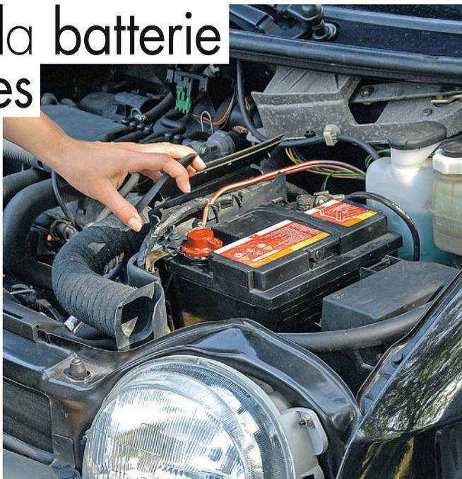
12 heures environ avec un chargeur d'ancienne génération. En cas d'urgence, un modèle récent (automatique) fait gagner du temps. Une tension inférieure à 10 V indique que la batterie est bonne à changer, même chose si la voiture dé-
