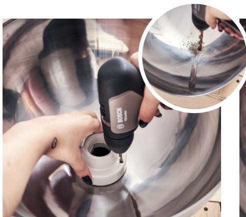
**2** Placez la douille au centre puis repérez les points de perçage avec un foret de Ø 4 mm. Retirez la douille et percez les trous de fixations. Déterminez l'inclinaison du saladier sur le pied. Repérez le point de fixation puis percez le saladier à l'aide du foret Ø 8 mm.
