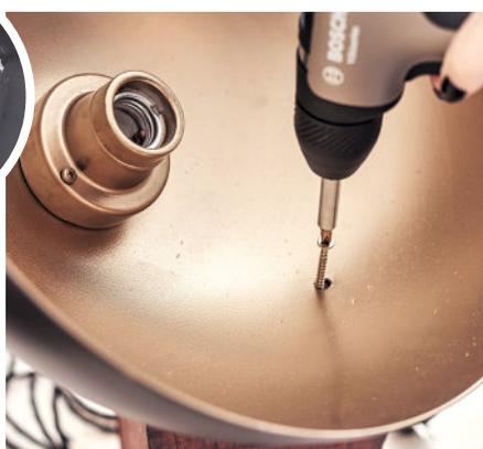
**8** Fixez l'abat-jour sur le piétement à l'aide d'une vis à bois Ø 6 mm. Au préalable, veillez à régler le couple de serrage de la perceuse-visseuse afin de ne pas déformer ni rayer le saladier en fin de serrage. Enfin, vissez l'ampoule puis branchez la lampe.
