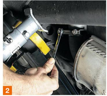
**2.** Posez la traverse de l'essieu arrière sur deux chandelles. Dévissez les écrous du collier maintenant le silencieux principal et le silencieux central. Puis déposez le second collier et ses caoutchoucs.
