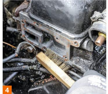
**4.** Côté culasse, éliminez les traces de l'ancien joint en papier à l'aide d'une brosse métallique souple pour ne pas rayer la surface.
