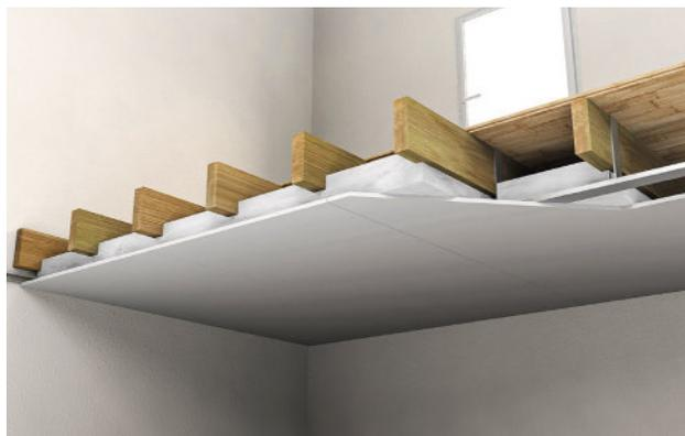
Le faux plafond suspendu est réalisable sous un plancher bois traditionnel aussi bien que maçonné. Il constitue une solution probante pour retenir la chaleur dans la pièce et, si besoin, faire barrage aux bruits. L'entraxe des suspentes peut aller jusqu'à 120 cm dans la longueur des solives.
