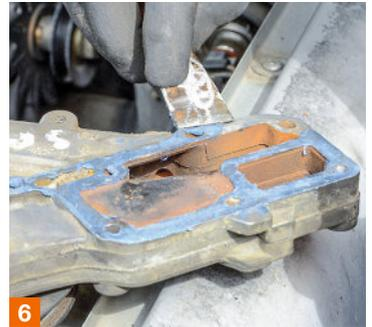
**6.** Ici la pompe (achetée d'occasion) ne dispose pas de joint. Enduisez les plans de joint (côté culasse et pompe) de pâte. Remontez la pompe en respectant les couples de serrage indiqué par le constructeur.
