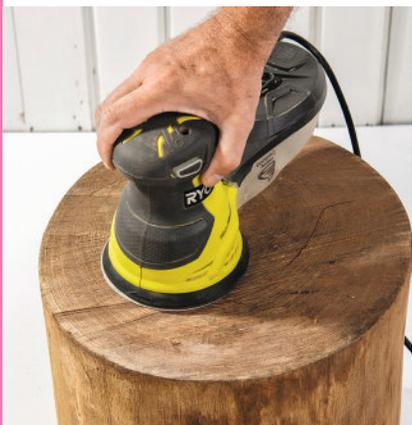
**3/** Poncez les extrémités afin d'atténuer les traces laissées lors de la coupe du billot à la tronçonneuse. Utilisez du papier abrasif n° 60 (gros) jusqu'au 100 (moyen).
