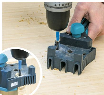
**6** Munissez-vous d'un gabarit de perçage, placez-le au-dessus des repères. Choisissez le diamètre en fonction de celui des tourillons. Délimitez la profondeur des perçages en enroulant un adhésif autour de la mèche ou à l'aide d'une butée de profondeur.
