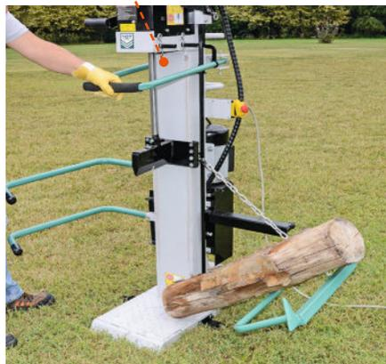
**Les bûches se fendent dans le sens des fils du bois**, jamais en travers. Évitez d'utiliser une section de bois coupée en biais. Elle risque en effet de glisser sur la table au contact du coin à fendre. Actionnez les deux poignées de descente pour abaisser le coin fendeur. Laissez-le descendre jusqu'à ce que les morceaux se séparent.
