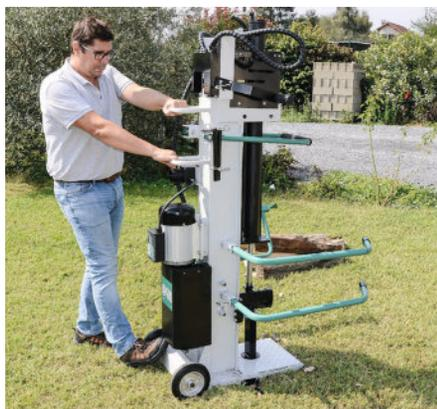
**Équipée de roues et de poignées de transport**, cette machine peut être déplacée. Attention, avec ses 170 kg, elle est lourde. Inclinez-la en vous aidant du pied pour éviter qu'elle ne bascule en arrière et ne tombe. Le transport se fait vérin replié et coin bloqué avec la cale de maintien sur la table.
