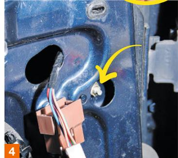
**3.** Démontez l'accoudoir à l'aide du tournevis pour dégarnir la portière. Dégrafez la garniture en tirant doucement dessus, puis débranchez les connecteurs électriques.
