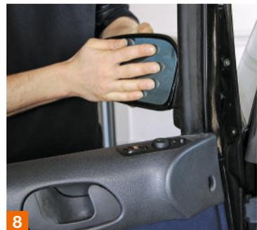
**7.** Connectez les fiches du rétroviseur et du lève-vitre. Procédez à un essai avant de remonter la garniture de porte dans l'ordre : habillage, accoudoir et cache supérieur.
