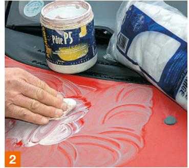
**2.** Pour raviver une peinture très oxydée, frottez les surfaces à la mèche de coton enduite de pâte à polir. Procédez par petits mouvements circulaires jusqu'au séchage presque complet du produit.
