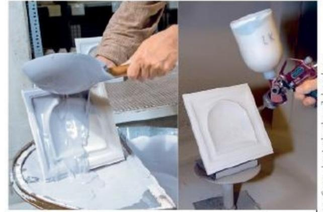
Glasieren im Wege der Schütttechnik oder durch Aufspritzen mit einer speziellen Spritzpistole verlangt eine sichere Hand.
