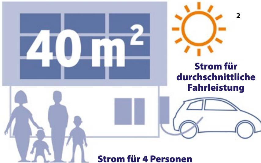
Eine 40 m<sup>2</sup> große Photovoltaikanlage mit einer Nennleistung von 7 Kilowatt produziert im Jahr rund 6650 Kilowattstunden. Damit sichert sie rechnerisch den durchschnittlichen Strombedarf einer vierköpfigen Familie und liefert zudem genug Strom für rund 15000 Kilometer Reichweite im Elektroauto.
