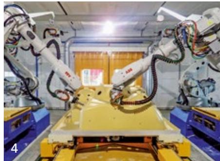
Hier werden die Wannen von riesigen Spezialmaschinen im Vakuum-Tiefziehverfahren geformt und direkt im Anschluss vollautomatisch verstärkt. Das Aufsprühen des wiederverwertbaren PU-Materials erledigen Hightech-Roboter.
