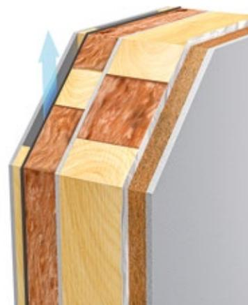
Das dreischalige „MultiTec“-Wandssystem von Kampa besteht aus einer Holzfaser-Instalationsebene, einer hochgedämmten Holzständer-Tragebene und einer wärmebrückenoptimierten Vorsatz-Dämmung. > [www.kampa.de](http://www.kampa.de)
