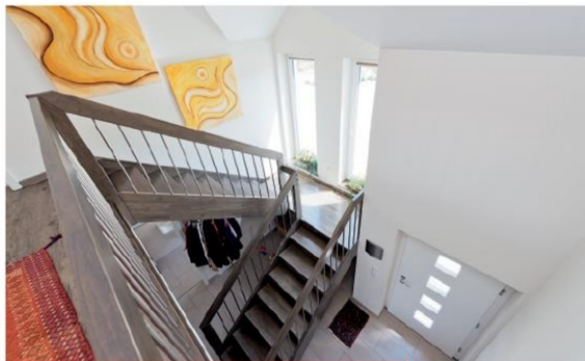
Die Stufen der dunkel gebeizten Buchen-Treppe, vom Gussek-Tochterunternehmen gefertigt, können leicht ausgetauscht werden. Dass sie nur eingesteckt sind und keinen direkten Kontakt zu den Wänden haben, wirkt sich auch positiv auf den Schall aus, der nicht direkt auf die Wände übertragen wird.
