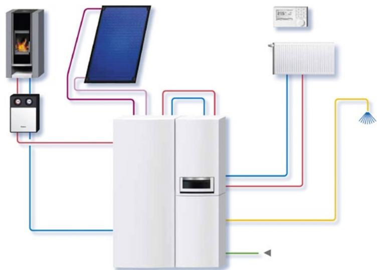
Gas-Brennwertheizung kombiniert mit zwei erneuerbaren Energiesystemen: mit Solarwärmanlage und wasserführendem Holzofen. Das spart Brennstoffkosten und reduziert die CO<sub>2</sub>-Emissionen. > [www.buderus.de](http://www.buderus.de)
