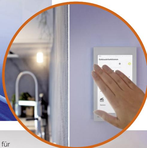
Über das Touchdisplay „Gira G1“ lassen sich Zeitschaltuhren einrichten oder eine Anwesenheitssimulation starten. Bedeckt man vor dem Schlafengehen das Display kurz mit der Hand, dann schaltet es nach einigen Minuten die Lichter aus.
