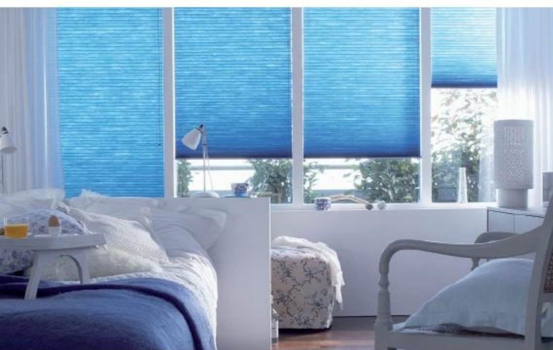
Sonnenschutz mit Wärmeschutz: Das Wabenplissee hat Stoffwaben, die als Luftkammern dienen und so Wärme speichern. Teba
