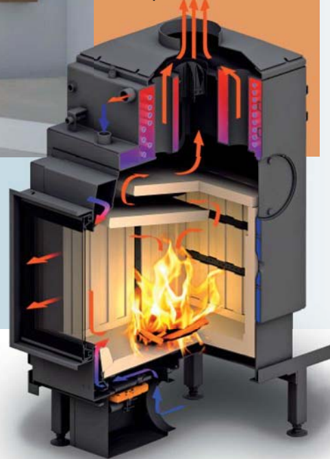
Heizeinsatz „Nova H 2 O“ in eingebautem Zustand und als Funktionsschema. www.spartherm.com
