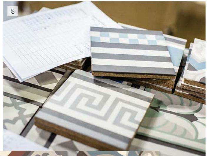
7 + 8 Für die Golem-Bodenfliesen werden farbige Feinstzeug-Töne von Hand in eine Form gefüllt und als dünne Intarsienschiicht mit dem Trägergranulat verpresst.
