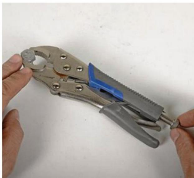
**Même si ce n'est pas sa tâche première, la pince étau peut être utilisée pour le vissage** ou le dévissage de vis ou de boulons. Le bout de la mâchoire est adapté. Pour ne pas abîmer les têtes de vis ou d'écrou, réglez l'ouverture des mors avec la vis. Pincez la tête sur le plat et resserrez la vis jusqu'à avoir la prise.
