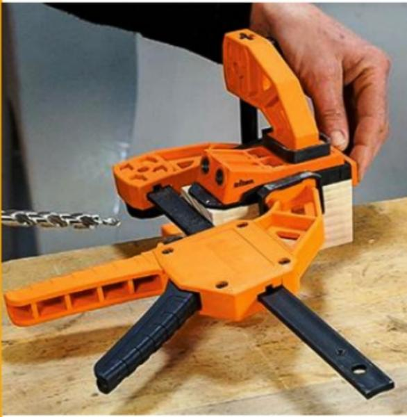
**3/** Un gabarit de perçage oblique et sa mèche étagée permettent d'usiner les montants. Les petites pièces et le gabarit doivent être maintenus sur l'établi à l'aide de serre-joints.
