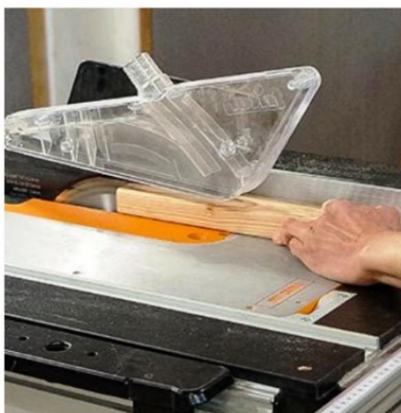
**1/Coupez de long les pièces de bois de la structure (section 50 x 50 mm) et les marches (40 et 54 x 32 mm). Les contremarches sont recoupées dans des lames de terrasse (27 x 145 mm).**
