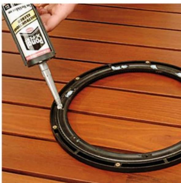
**7/** Centrez et fixez le support tournant (acheté dans le commerce) sur la table avec des vis inoxydables Ø 3 x 30 mm. Placez du mastic-colle sur la partie mobile tous les 10 cm environ.
