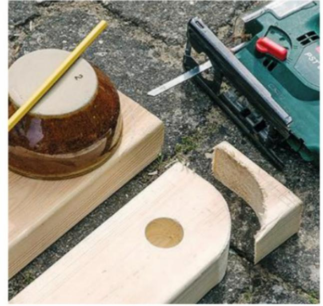
**3** Les montants de l'échelle horizontale ne sont pas chanfreinés, mais découpés en quart-de-rond à la scie sauteuse. Astuce classique, un récipient ou autre objet rond est utilisé pour tracer l'arrondi.
