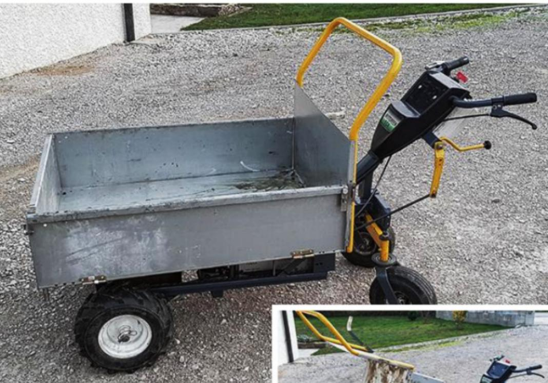
*Le moteur électrique est alimenté par deux batteries 12 V de voiture, offrant ainsi une belle autonomie, pour une charge maxi d'environ 150 kg.*
