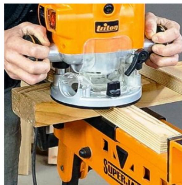
**2/Chanfreinez les pièces destinées à former les marches. Utilisez une défonceuse munie d'une fraise pilote à 45° ou à quart-de-rond. Les pièces sont maintenues dans un établi-étau.**
