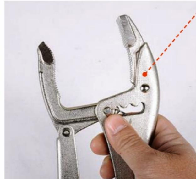
D'autres pinces étaux sont équipées d'un système à crémaillère (ou boutonnière). Elles offrent plusieurs ouvertures de mâchoires et permettent une plus grande polyvalence que les outils mono-serrage. Selon les fabricants, le nombre de positions d'ouverture varie entre 4 et 6 positions. L'ouverture maxi va jusqu'à 175 mm.
