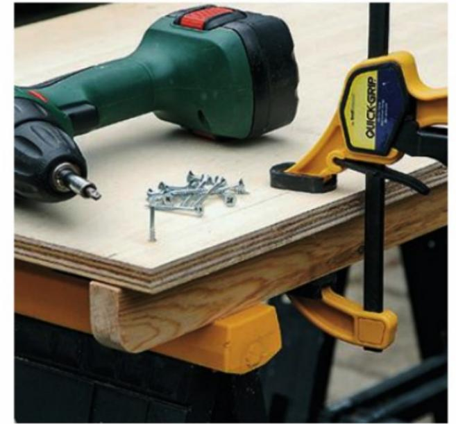
**12** Les longerons sont vissés sous la planche de contreplaqué. Les têtes des vis doivent être noyées : laissées apparentes, elles ne tarderaient pas à déchirer la fragile couche de mousse.
