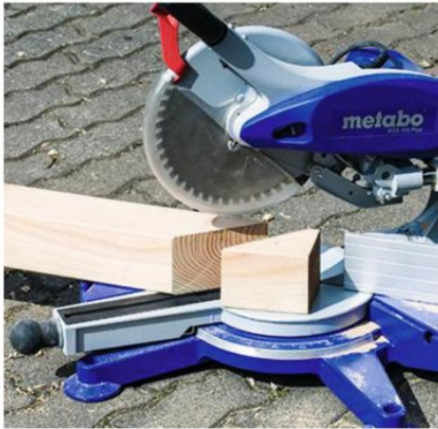
**1** Les différents éléments de l'ossature sont mis à longueur et coupés à l'angle souhaité avec une scie à onglet électrique. Sa capacité doit permettre de tronçonner des sections de 90 x 90 mm.
