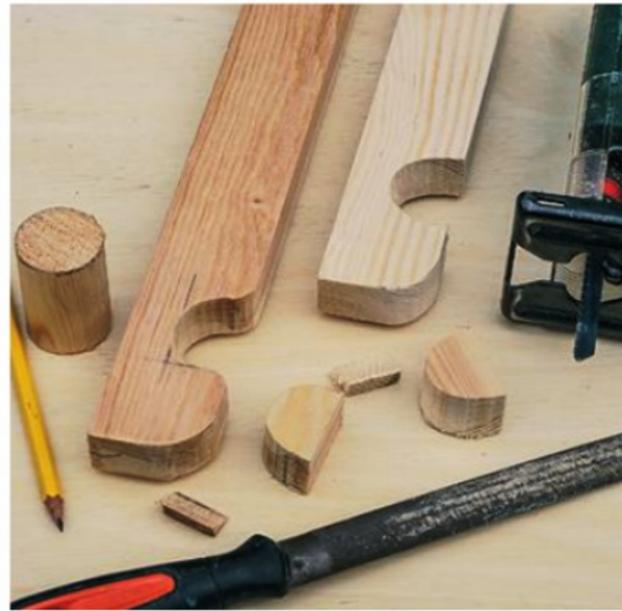
**11** La planche à abdos est équipée de longerons qui comportent trois usinages : un quart-de-rond à chaque extrémité, et une encoche de maintien. Un tronçon de barreau sert de gabarit de traçage.
