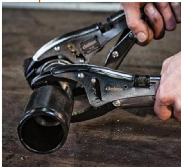
**La pince étau à crémaillère** effectue des serrages assez précis de pièces fragiles. L'amplitude d'ouverture des mâchoires aide à affiner le réglage de la force de pression.
