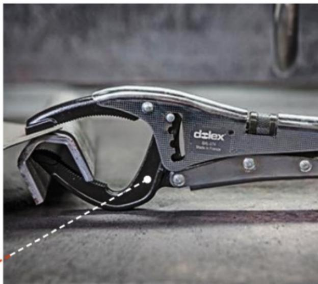
Cet outil est généralement en acier et chrome vanadium pour résister aux chocs, à la chaleur, aux éclats de soudures ou aux produits chimiques. Le corps est en tôle emboutie et les mâchoires (appelées aussi mors ou becs) sont forgées dans la masse pour plus de résistance et équipées de dents pour une meilleure accroche. Les pinces ont en moyenne une largeur de 10 à 17 mm limitant l'encombrement. Pour une longueur de 10 à 30 cm.
