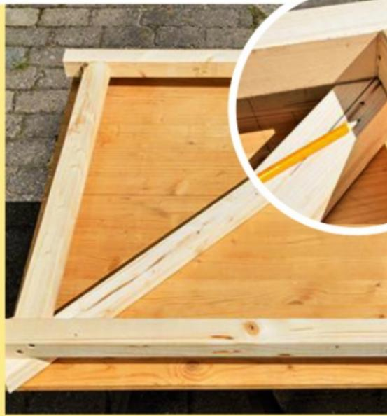
**16** Placez un tasseau de même section sur la diagonale et marquez les coupes à effectuer au niveau des angles intérieurs du rectangle formé par le cadre.
