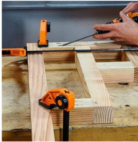
**4/** Enfoncez les vis à bois à tête plate à l'aide d'un embout de vissage allongé dans le perçage à épaulement. Bridez les pièces avec des serre-joints au niveau des assemblages.
