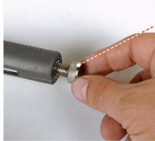
Une vis de réglage permet d'augmenter ou de réduire la force de serrage en fonction des pièces à maintenir. Cette vis, positionnée sur l'arrière de la pince ou au-dessus, agit sur la mâchoire inférieure mobile, en augmentant l'ouverture ou en la réduisant de quelques millimètres. La force de serrage maxi varie selon les modèles de 50 à 700 kg.
