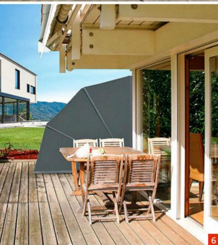
**1. Sans cadre.** De style épuré, il se compose de profilés (H. 1,70 m) en aluminium anodisés thermolaqués (label Quali Steel coat) et d'un verre trempé (ép. 10 mm). Conçu pour le bord de mer, il résiste à un vent jusqu'à 180 km/h. À partir de 850 €/m. Memoral.
