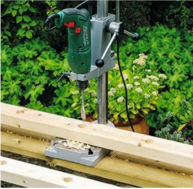
**1** Les trous borgnes sur les (non débouchants) montants des espaliers sont effectués à l'aide la perceuse (sur support ou à colonne) et une mèche plate, à l'aide d'une butée de profondeur.
