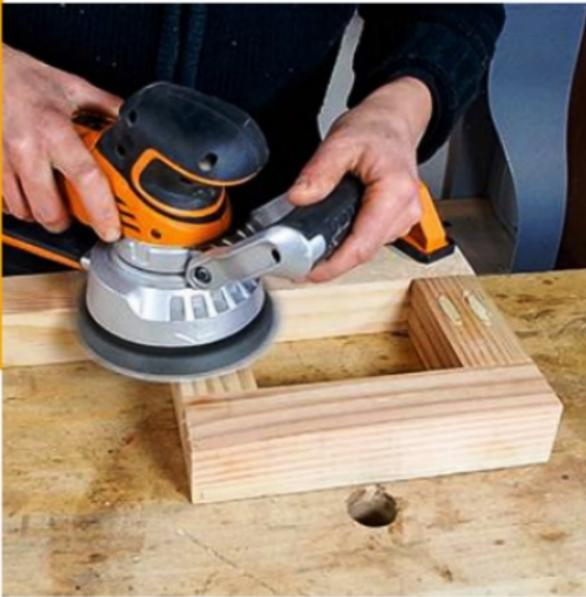
**5/** Rebouchez les perçages obliques à l'aide de bouchons ou de pâte à bois. Les éléments assemblés sont ensuite poncés afin de rendre l'assemblage parfaitement invisible.
