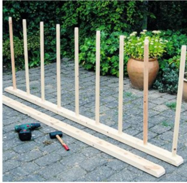
**2** L'extrémité des montants est chanfreinée à 45°, à la scie ou à la ponceuse à bande. Les barreaux sont emboîtés, puis vissés en bout avec des vis inoxydables de 5 x 60 mm. Il n'est pas indispensable de les coller.
