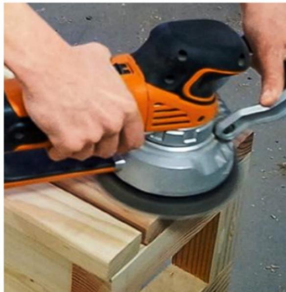
**8/** Ponchez l'ensemble avec un abrasif fin, puis appliquez une protection à l'aide d'une huile dure ou d'une peinture microporeuse qui permet de conserver un certain temps l'aspect du bois.
