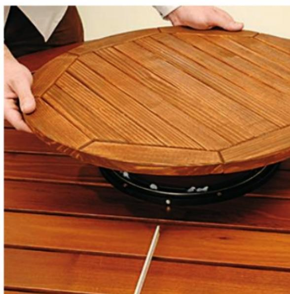
**8/** Mettez en place le plateau en le centrant avec soin. Corrigez légèrement au besoin. Maintenez une pression pendant quelques minutes pour que la colle adhère parfaitement.
