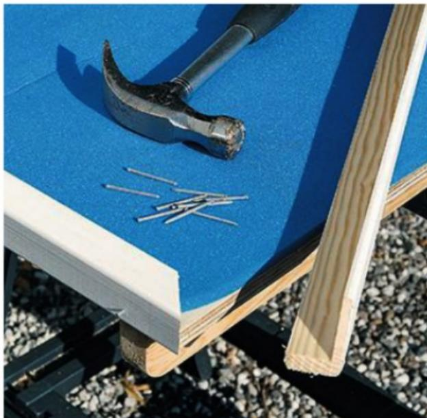
**13** La mousse est posée sur le contreplaqué. Si elle tend à s'enrouler, des morceaux d'adhésif double face la tiennent en place, le temps de clouer les cornières de maintien, coupées d'onglet.
