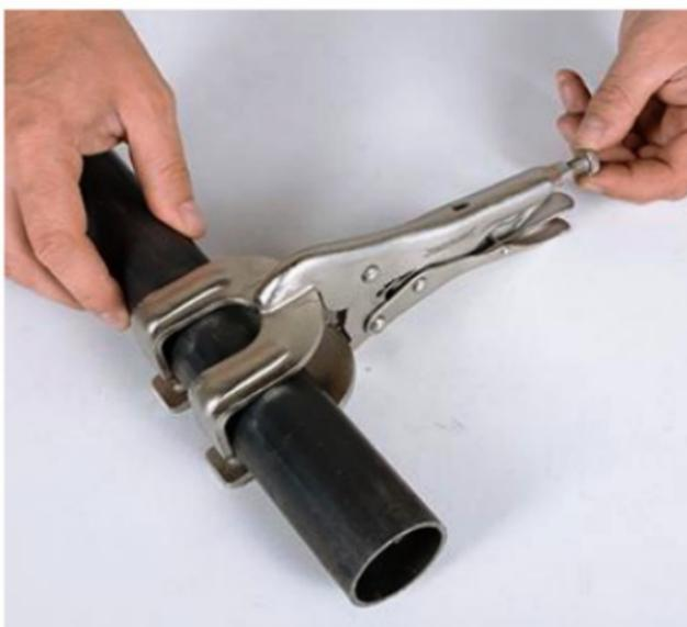
**Le profilé en « U » des mors** de ce modèle convient parfaitement au serrage des corniers et de tous les profilés métalliques. Ils peuvent aussi facilement maintenir des tubes cylindriques. Il ne faut pas hésiter à serrer la vis de réglage pour éviter que la pièce ne glisse.
