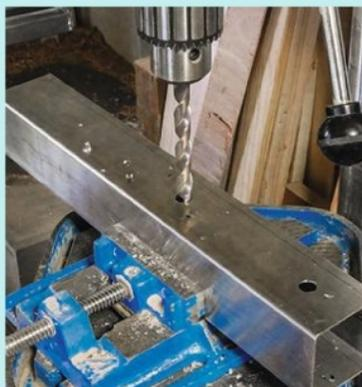
**28** Les bases des poteaux sont des tubes carrés en Inox de 60 x 60 mm. Deux perçages Ø 12 mm permettent de placer des vis Inox de 6 x 70 mm.
