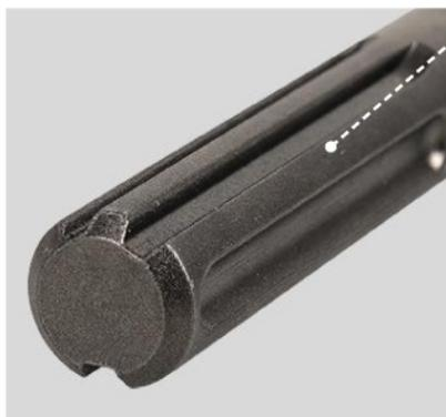
**Le SDS Max** est réservé aux travaux plus intensifs (gamme professionnelle) et aux perforateurs de plus de 4 kg pour une puissance généralement supérieure à 1 200 W. La transmission de la puissance de rotation est assurée par trois cannelures. L'emmanchement est de 17 mm de diamètre (longueur maxi du foret: 600 mm).
