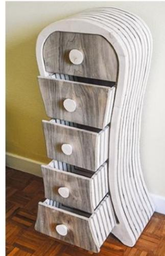
*Les couches sont collées et vissées entre elles en veillant à décaler les vis pour ne pas buter sur une autre vis.*
