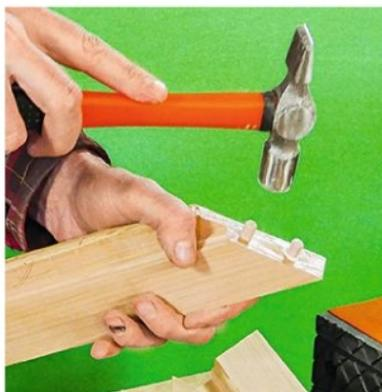
**6/** Encollez les parties en contact (coupes d'onglet) et les logements des tourillons, assemblez et serrez avec des serre-joints ou un étau portatif. Utilisez une colle à bois de type vinylique.
