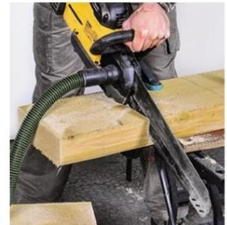
Si la coupe de bois de forte section (225 x 75 mm) ne pose pas de problème, l'aspiration est peu efficace malgré le raccordement à un aspirateur de chantier.
