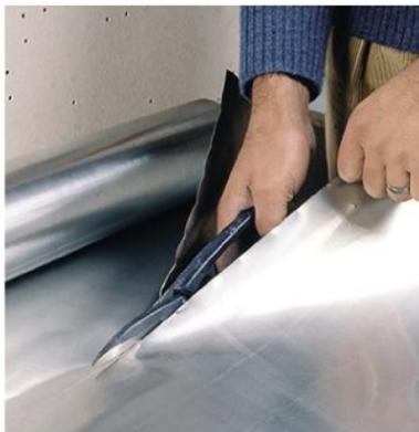
**1/** Avec une cisaille à tôle, découpez une longueur égale à celle du fond de la jardinière additionnée de deux fois la hauteur, et d'une largeur égale à la largeur intérieure.
