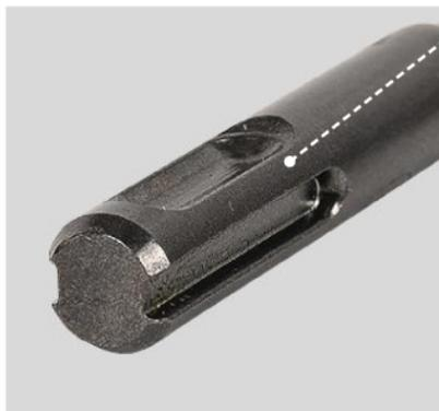
**Le SDS+** équipe les perforateurs pesant entre 2 et 4 kg et développant une puissance jusqu'à 1 200 W. La transmission de la puissance de rotation est assurée par deux cannelures. L'emmanchement est de 10 mm de diamètre (longueur maxi du foret: 1 000 mm).
