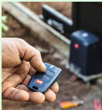
**34** Vérifiez l'absence d'obstacles sur la trajectoire du vantail. Enclenchez la procédure d'autoconfiguration. Les fins de course se règlent alors automatiquement.
