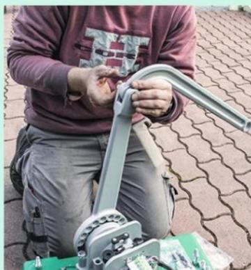
**26** Sur chacun des moteurs du portail, assemblez les bras d'ouverture/fermeture en installant les tampons en caoutchouc et les boulons.
