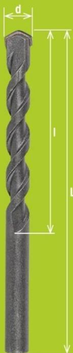
Avant de choisir son foret, trois cotes sont à vérifier: le diamètre de la pointe (d) qui définit la taille du perçage, la longueur de l'hélice (l) qui détermine la profondeur maximale de perçage et la longueur totale du foret (L). Attention plus un foret est long, moins il est stable. En règle générale, les matériaux durs se percent à une vitesse de 1 000 à 1 500 tr/min.
