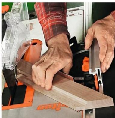
**4/** La table d'usinage peut recevoir un module scie circulaire, équipé d'un guide pour obtenir des coupes d'onglet précises. Maintenez fermement les pièces contre le guide pendant l'opération.
