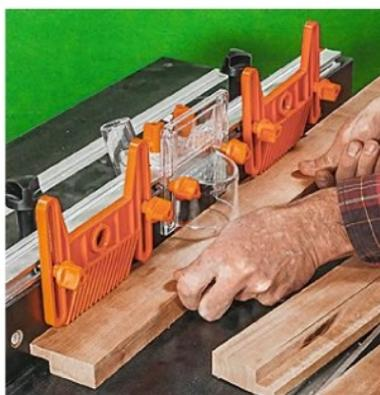
**1/** Débitez les montants et traverses du cadre dans des planches (ici de merisier). Usinez la feuillure destinée à contenir le tableau avec une défonceuse, de préférence en poste fixe.
