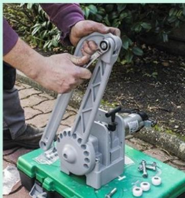
**27** Serrez l'articulation du bras à l'aide d'une clé plate en position ouverture, puis réglez avec une clé hexagonale la vitesse de la motorisation.
