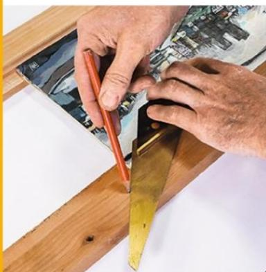
**3/** Tracez les coupes d'onglet avec une équerre à 45°. Pour guider votre tracé, placez directement le tableau dans les feuillures; vous limitez ainsi les risques d'erreur ou d'imprécision.
