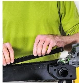
Les deux lames sont vissées sur un guide qui limite leurs vibrations tout en permettant de passer entièrement dans le matériau découpé.
