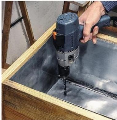
**6/** Percez plusieurs trous dans le zinc et le fond en bois pour assurer le drainage. Pour éviter que l'eau ne s'infilte entre le zinc et le bois, insérez dans ces trous des tronçons de tuyau en plastique.
