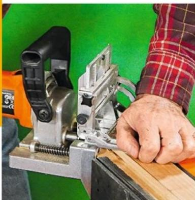
**5/** Une tourillonneuse double apporte de la précision et de la résistance aux assemblages en onglet. Recoupez les tourillons de Ø 8 mm pour obtenir des longueurs de 20 mm seulement.
