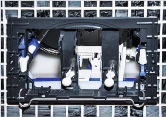
**25** Fixez la platine de commande (support de la plaque de finition) en tournant les petits verrous blancs situés sur les côtés. En bas, les deux éléments à boule seront sollicités par les deux boutons de commande de la plaque pour actionner la chasse d'eau.
