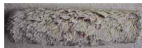
Rollen mit Polyacrylbezug haben ein befriedigendes Aufrichtverhalten. Sie eignen sich für anspruchlosere Aufgaben
