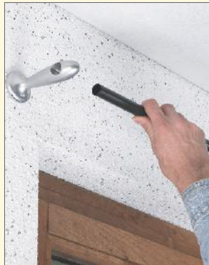
3 Wandmontage: Das Gardinenrohr wird in den wandmontierten Halter eingeschoben und von oben mit einer Madenschraube fixiert.
