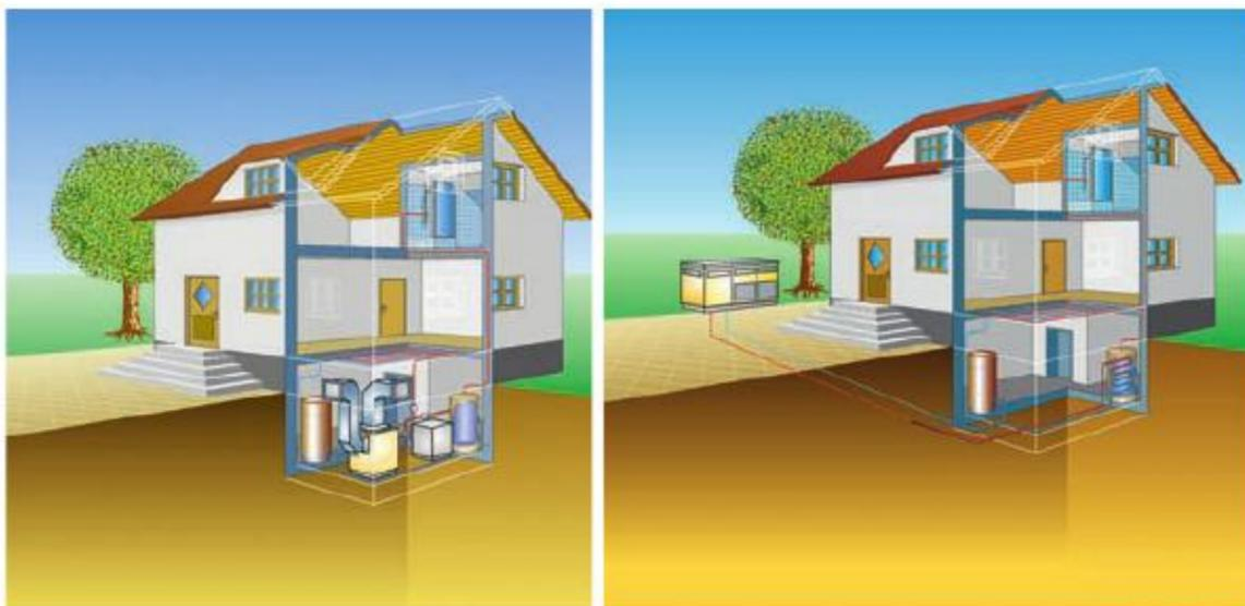
**Perfekt für den nachträglichen Einbau:** Luft-/Wärmepumpen in Innen- oder Außenaufstellung nutzen die Umgebungsluft als Wärmequelle und sind besonders günstig in der Anschaffung. Besonders effektiv arbeitet die Luft-/Wasser-Wärmepumpe bei hohen Außentemperaturen, im Winter benötigt sie daher mehr Antriebsenergie als erdgekoppelte Systeme. *BWP*
