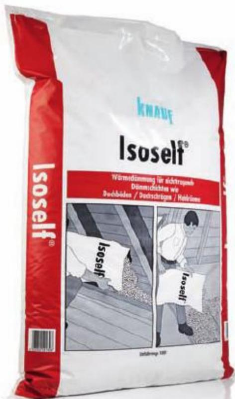
**Wärmedämmung von Fußböden:** Bei der nachträglichen Dämmung von Holzbalkendecken helfen spezielle Dämmstoffschüttungen aus Perliten. Das leichte, natürliche Material wird zwischen die Fußbodenbalken eingebracht. Nach Einbau eines Rieselschutzes oder einer Dampfbremse wird das Material einfach lose und trocken in die Balkenfelder geschüttet und über die Balken abgezogen. *Knauf Perlite*
