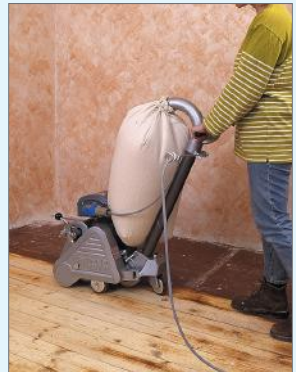
3 Ein solcher Walzenschleifer entfernt alle alten Farbschichten und gleicht die Höhenunterschiede der Dielen untereinander aus.
