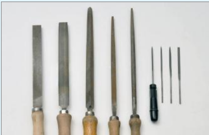
Feilen unterscheidet man nach Form, Hieb und Anwendungsgebiet. Hier eine Halb- rund-, Flach-, Dreieck- und Rundfeilen sowie einige Schlüsselfeilen.
