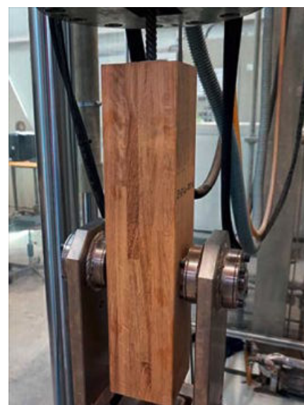
Abbildung 5: In die Prüfmaschine eingebauter Prüfkörper während eines Ermüdungsversuchs.
