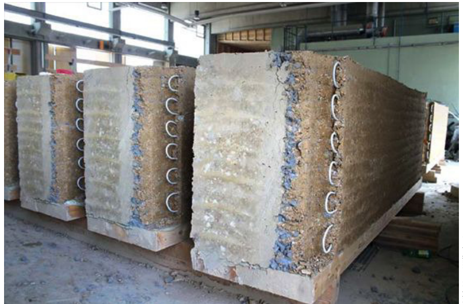
Fertig produzierte Stampflehmelemente mit integrierter Dämmschicht aus Schaumglasschotter und Wandheizungsschleifen.
