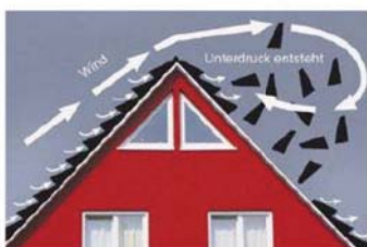
Windangriffe können direkt unter den Ziegeln wirken oder auf der Gegenseite durch Umwirbelungen und Unterdruck. www.wienberger.de
