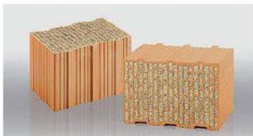
Die Wärmedämmeigenschaften klassischer Ziegel sind nicht sehr gut, darum werden vermehrt porosierte Mauerziegel mit Dämmkernen aus Perlit, Mineralwolle oder wie hier aus natürlichen Holzfasern hergestellt. [www.unipor.de](http://www.unipor.de)
