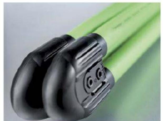
So sieht eine Erdwärmesonde aus. Für maximale Effizienz, muss sie dicht sein. Die „RAUGEO Sonde PE-Xa“ verfügt über eine raue Außenschicht, die in Kombination mit dem Verfüllmaterial „RAUGEO fill rot“ für Systemdichtheit und besonders gute Wärmeübertragung sorgt. [www.rehau.de](http://www.rehau.de)
