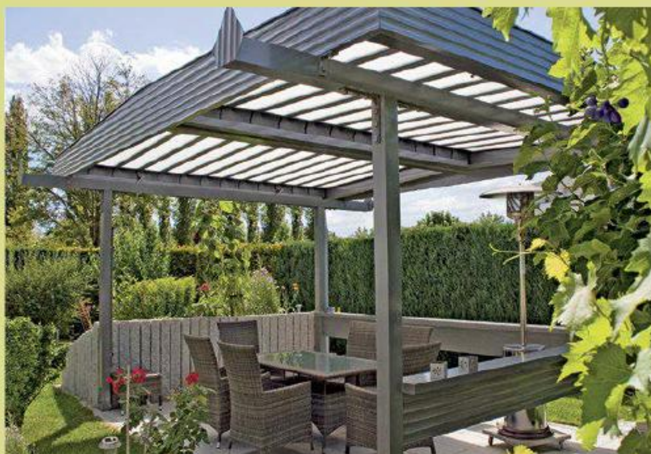
Bei diesem freistehenden Terrassendach sorgen thermochrome Glaslamellen dank temperaturabhängiger Verdunkelung und Drehbarkeit für ein ausgewogenes Verhältnis von Sonne und Schatten. Je höher die Temperatur des Glases, desto dunkler färbt es sich. Die Beschattung erfolgt ausschließlich durch die Aufheizung der Scheiben. www.fledmex.com
