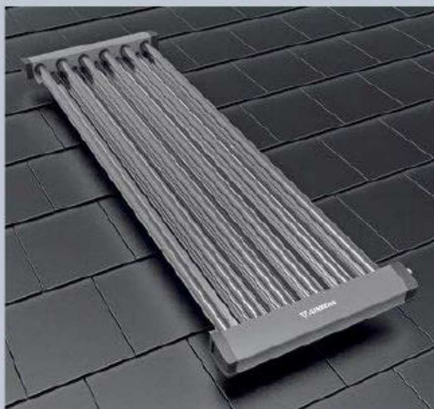
Der neue Vakuum-Röhrenkollektor „VK 120-2 CPC“ ist für die Aufdach- und Fassadenmontage geeignet und lässt sich auch liegend oder aufgeständert auf Flachdächern betreiben. www.junkers.com
