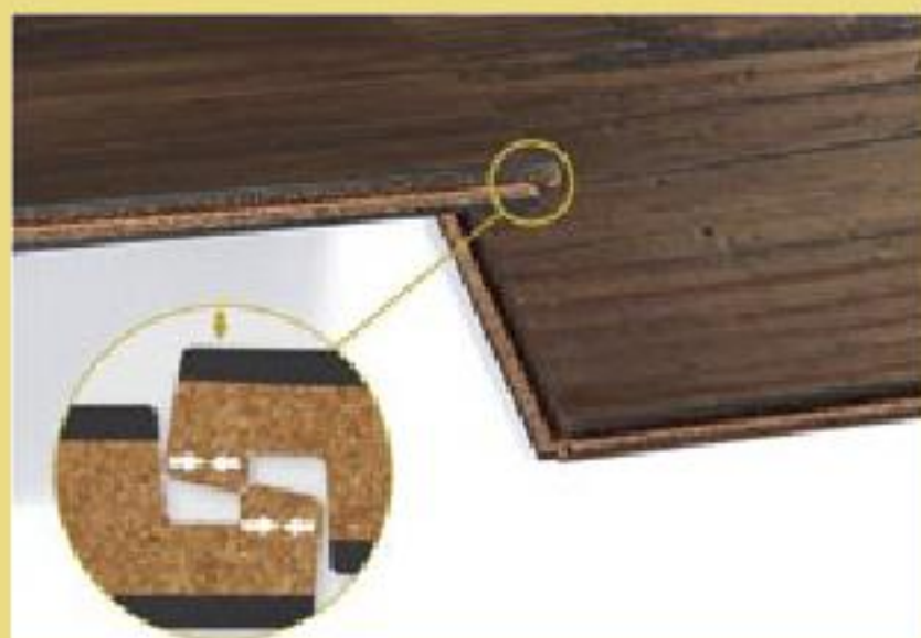
Spezialität aus Kork: Die Elemente sind aus speziellem Hydro-Kork, die Ober- und Unterlage ist aus Vinyl, die Optik ist Holz. www.amorim.de
