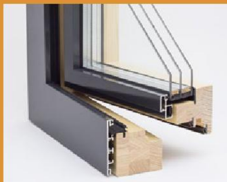
Neues Holz-Alu-Fenster Duoline mit einem U_w -Wert von 0,79\text{ W}/(\text{m}^2\text{K}) bei 88 mm Holzprofil und Dreischeibenaufbau „4-18-4-18-4“ (in mm). www.drutex.eu
