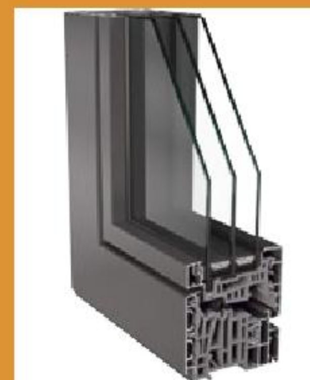
Alufenster mit 48-mm-Dreifachglas, U_g -Wert 0,5\text{ W}/\text{m}^2\text{K} , U_w -Wert 0,78\text{ W}/\text{m}^2\text{K} . www.finstral.de
