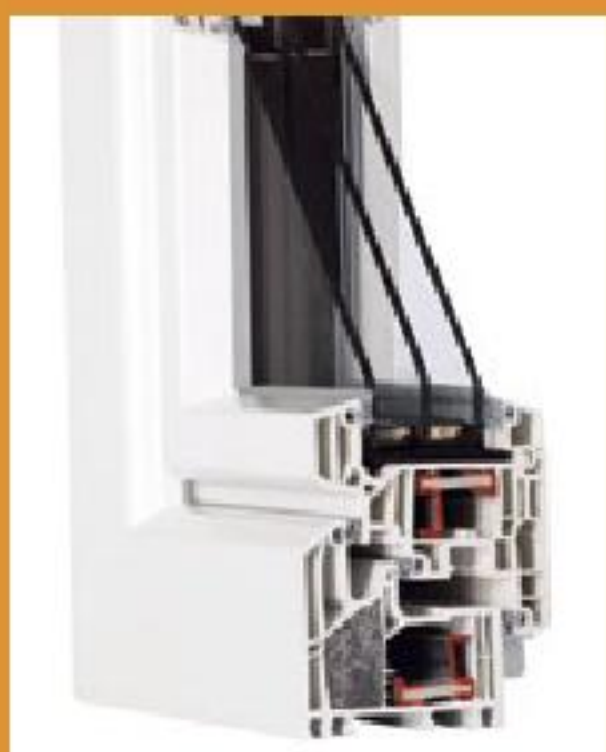
PVC-Fenster: 3-Scheiben, Rahmen 80 mm, Flügel 95 mm, Uw-Wert bis 0,74 W/m 2 K. www.hoco.de
