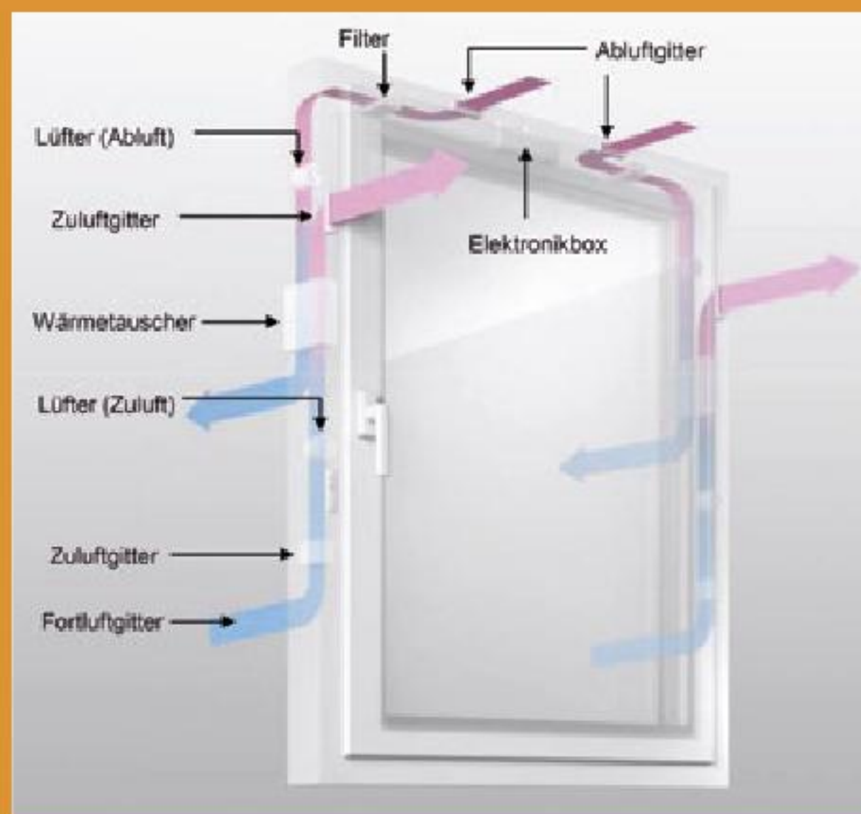
Beispiel für einen modernen, im Fensterrahmen integrierten Fenster-lüfter mit Wärmerückgewinnungstechnik. (Abb. ift Rosenheim/Rehau aus Dokuband Sonderschau EcoDesign)
