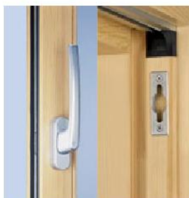
„Patio Life“ für Hebe-Schiebetüren: Mit einer 180°-Drehung des Türgriffs nach oben öffnet sich nur die Dichtung des Flügels und ermöglicht so einen sicheren Luftwechsel, denn die Verriegelung über die Schließstücke bleibt.
