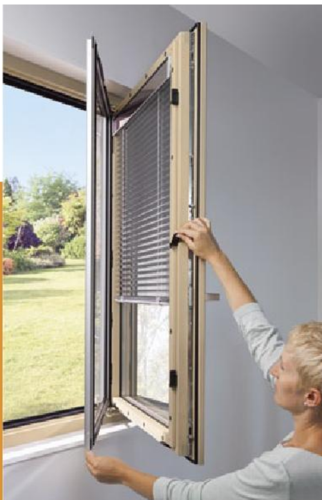
PVC-Fenster: 3-Scheiben, Rahmen 80 mm, Flügel 95 mm, Uw-Wert bis 0,74 W/m 2 K. www.hoco.de
