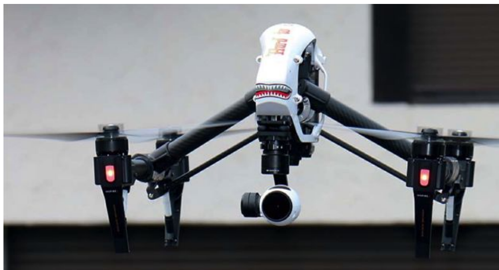
Zukünftig auch im Zimmererhandwerk ein Thema: Bewertung und Begutachtung von schwer zugänglichen Gebäudeteilen mittels Drohnen. Mehr dazu auf der Sonderschau der Messe.
