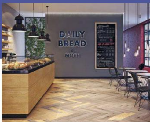
PURLINE Bioboden wineo 1500 ist ein dauerelastischer Polyurethanbelag aus Raps- oder Rizinusöl sowie natürlichen mineralischen Komponenten wie Kreide. Im Bild: Wood XS Garden Oak/Island Oak Moon. www.ecuran.de
