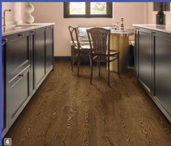
Als mineralischer Designboden bezeichnet werden hier in aller Raffinesse farbchangelnde Holzplanken mit lebendigem Holzdekor nachempfunden. Der Digitaldruck des Dekor-designs ist lichtecht. Basis ist eine 6 mm dünne wasserfeste mineralische Trägerplatte. Java Schlosseiche von www.kwg-kork.de .
