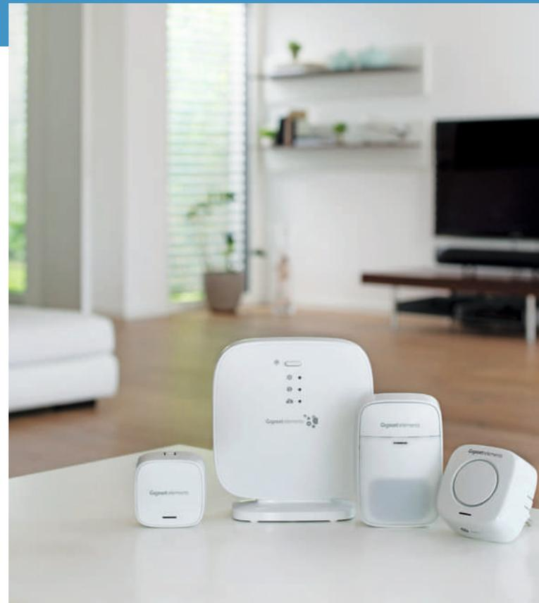
Homematic IP alarmiert auch ohne Internet-Verbindung. Der Grund ist die direkte Funk-Kommunikation zwischen den Sensoren zum Beispiel dem Tür-/Fensterkontakt und dem Access Point. eQ-3
