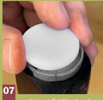
**07** ... mit einem Schlitzschraubendreher aus der Basis gelöst werden und ein neues oder anderes Gleitteil lässt sich platzieren.
