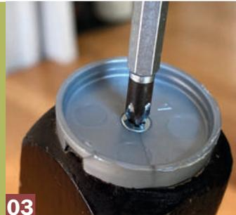
**03** Den Aufnahmenapf aus Kunststoff auflegen und die kleine Holzschraube am besten gefühlvoll mit einem Handschraubendreher eindrehen.
