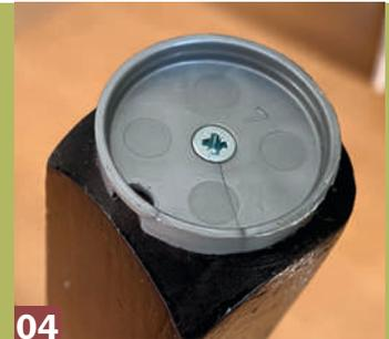
**04** Die Schraube muss genau bündig sitzen, damit keine Spannungen entstehen. Das Basisteil ist jetzt bereit für die Aufnahme des Einsatzes.
