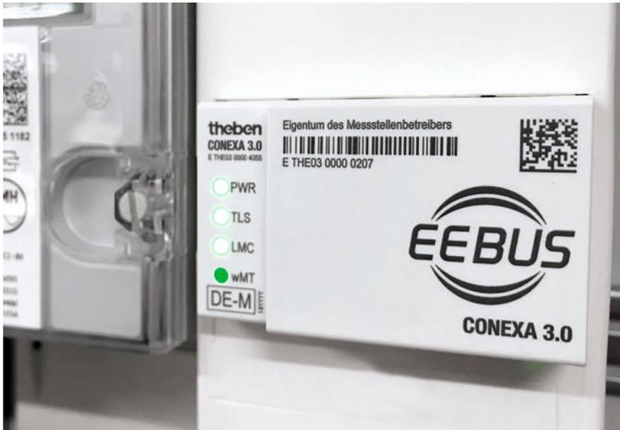
Kommunikator: Das Gateway Conexa 3.0 von Theben bietet Platz für ein Kommunikationsmodul, das einen zusätzlichen Datenkanal des SMG für Kommunikationsdienste im Energiebereich nutzen kann.
