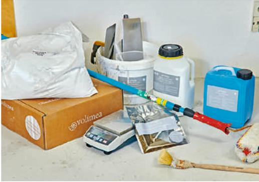
**13** Produktwechsel für den Sichtboden: Grundierung, Spachtelpulver, Pigment und Harz – daraus wird der neue Boden, der die alten Fliesen modern-trendig ersetzt.
