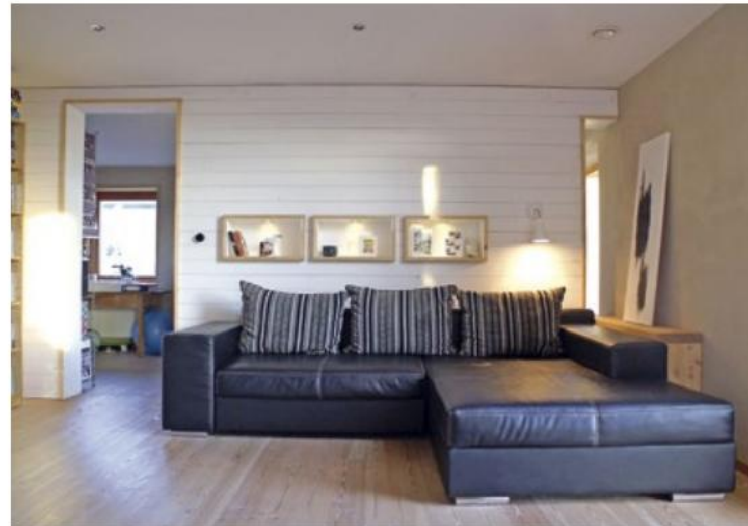
Sitzecke mit rückbaubarer Trennwand: Falls es neue Familienverhältnisse einmal fordern sollten, lässt sich die holzbeplankte Holzständerwand auch leicht wieder herausnehmen – der Fußboden läuft gut durchdacht durch.
