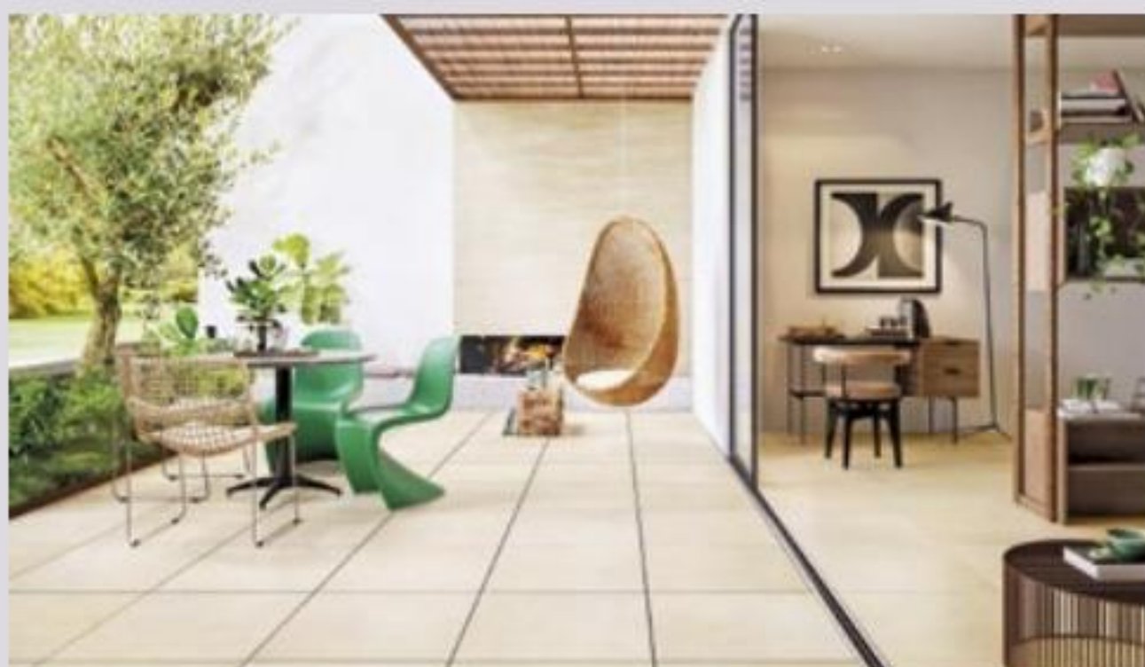
Dass man mit Keramik innen und außen verbinden kann, zeigt dieses Beispiel. Während innen die dünnen Fliesen verklebt werden, liegen die dann 2 cm dicken Outdoor-Elemente lose auf Splitt. Optisch also eine durchgängige Lösung. www.villeroy-boch.de
