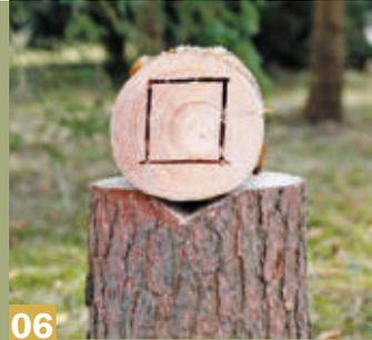
**06** ... Schnitte werden besser auf einem mit einer V-Kerbe versehenen Baumstumpf ausgeführt. Die Kerbe hält das Werkstück in Position.
