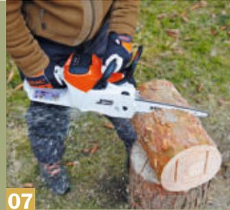
**07** Der Baumstamm wird an der den Schnitten gegenüberliegenden Seite schräg abgesägt – dadurch entsteht die Dachschräge.
