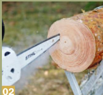
**02** Jetzt stechen Sie mit der Carving-Schiene ganz langsam in das Werkstück ein. Vorsicht, es besteht erhöhte Rückschlagsgefahr.
