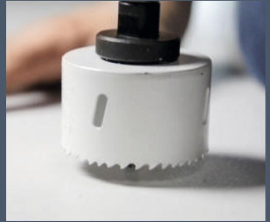
**9** ... verwendet einen Akkuschauber und schneidet das Kreisrund mit einer entsprechenden Lochsäge aus.
