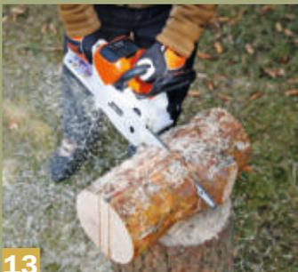
**13** Anschließend legt man mit einem vertikalen Sägeschnitt quer zum Baumstamm das Dachbrett für den Vogelnistkasten frei und ...
