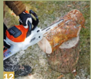
**12** ... aus dem Kern des Baumabschnitts heraus, indem man mit der Motorsäge zwei parallele Schnitte ausführt.
