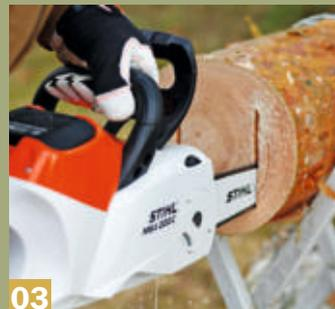
**03** Anschließend folgt ganz parallel der zweite Schnitt. Die Schnitte werden dabei stets von oben nach unten ausgeführt.
