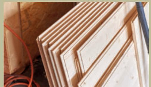
**4** Es handelt sich dabei um Massivholz-Mehrschichtplatten, die mit einem Nut- und-Feder-Kantenprofil ausgestattet sind und sich ohne Sichtfugen verlegen lassen.
