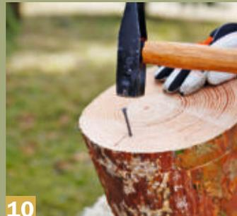
**10** Im nächsten Schritt wird die anfangs abgesägte Baumstammescheibe mit zwei, drei Nägeln als Boden auf die gerade Unterseite genagelt.
