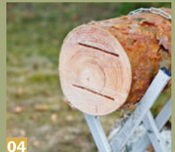
**04** Drehen Sie nun den Baumabschnitt im Sägebock, sodass die weiteren Schnitte wieder von oben nach unten ausgeführt werden können.
