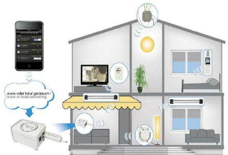
**Prinzip Funk-Steuerung:** Eine zentrale Basisstation regelt alle Vorgänge im Haus. Sie schickt per Funksignal Steuerungsbefehle an die ins System eingebundenen Schalter. Umgekehrt empfängt der Server per Funk Informationen vom Bedienterminal, von Fühlern und Funkschaltern. Die einzelnen Komponenten sitzen in der Regel verteilt im Haus in der Nähe der gesteuerten Geräte und Einrichtungen. [www.rademacher.de](http://www.rademacher.de)
