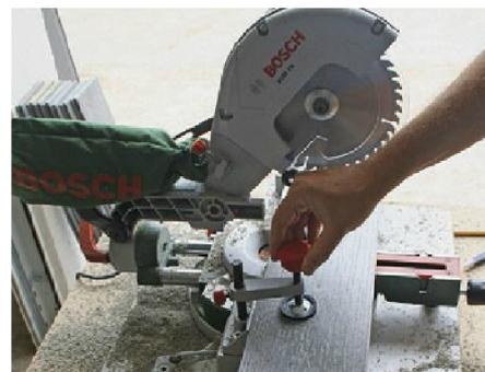
3. Hilfreich auch die Feststelleinrichtung, mit der das Werkstück zusätzlich fixiert werden kann.
