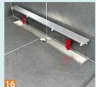
**16** Die Abdeckung – als Edelstahl-Sichtabdeckung oder als Fliesenmulde – wird mit Abstandshaltern bestückt und eingebaut.
