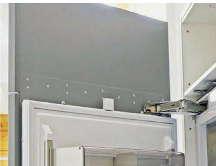
17. Von hinten wird die oben ergänzende Front mit der Kühlschrankfront zusammengefasst.
