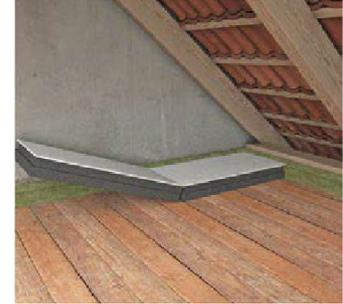
2. Die Elemente werden per Nut und Feder verbunden, ohne Verklebung oder Verschraubung.
