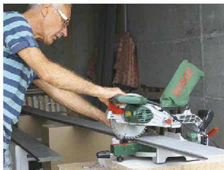
1. Die Dielen der rechteckigen Teilfläche konnten mit der Zugsäge auf Endlänge gebracht werden.
