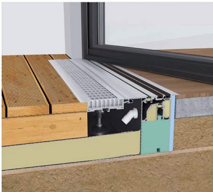
Schnitt durch einen fertiggestellten barrierefreien Zugang zu einer Dachterrasse in Holzbauweise
