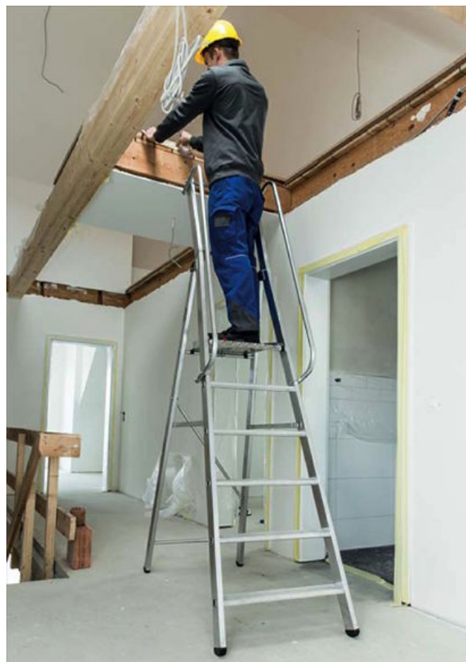
Zusätzliche Querverstrebungen, eine Spreizsicherung mit zwei hochfesten Perlengurten sowie die konische Bauweise sorgen für die Standsicherheit der Leiter.
