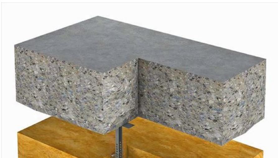
Auch bei Unterdecken sind, wie bei der Fassade auch, Unterkonstruktionen aus Metall oder auch aus Holz möglich.
