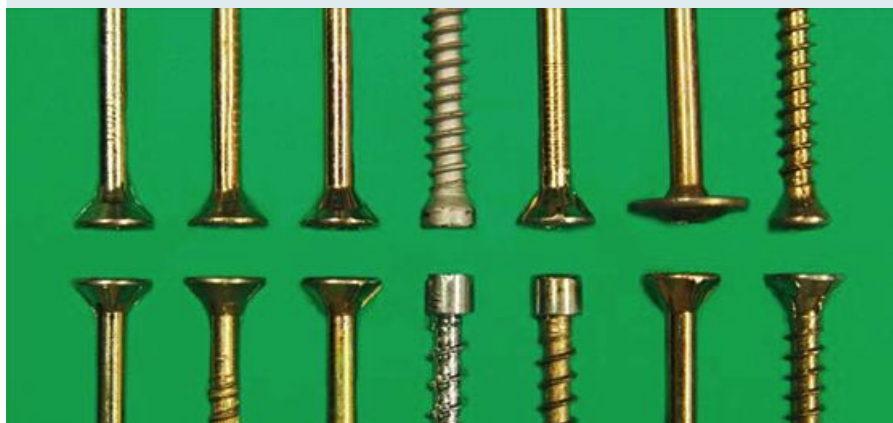
Bild 3: Ausbildung von Schraubenköpfen
