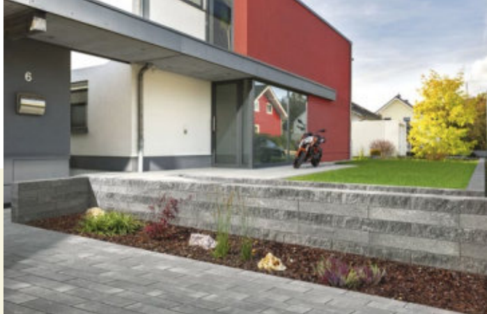
Die Wirkung der Adina-Mauer von Kann entsteht durch Steine mit unterschiedlichen Sichtseitenvarianten. Eine Seite ist gestrahlt, die andere gebrochen.
