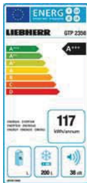
EU-Label am Beispiel einer Gefriertruhe der Effizienzklasse A+++ mit 200 l Nutzinhalt, einem Jahresverbrauch von 117 kWh und einer Geräuschemission von 38 dB
