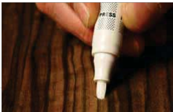
Kratzer und Dellen lassen sich mit Hilfe von geschmolzenem Wachs ausbessern und anschließend wieder ölen oder versiegeln.
