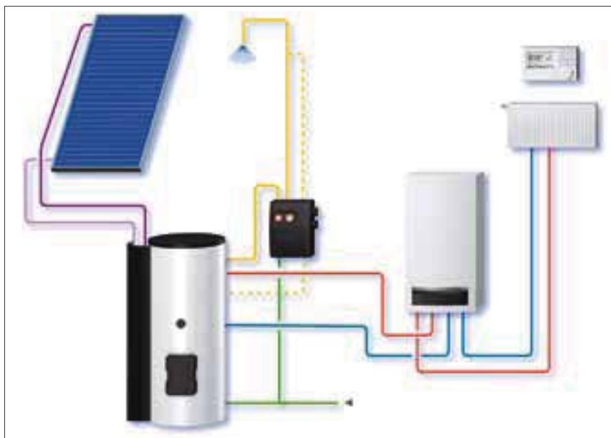
Schema der solaren Warmwasserbereitung. Für die Heizung sorgt allein der konventionelle Kessel.
