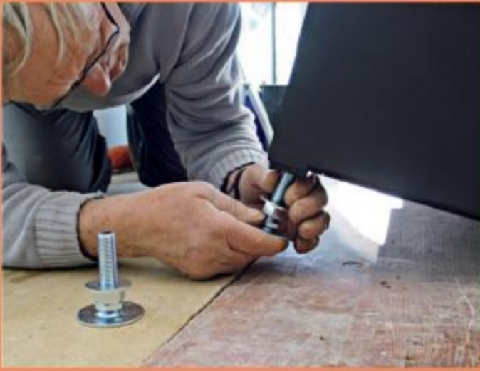
4. Dank höhenverstellbarer Füße lässt sich die Brennzelle dann später perfekt ausrichten.
