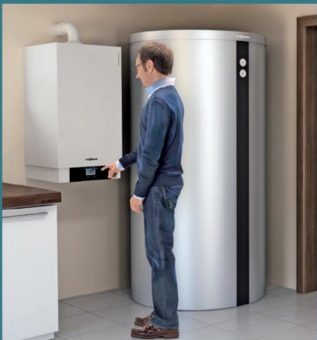
Das Gas-Mikro-KWK-Wandgerät Vitotwin 300-W ist hier mit einem 750-Liter-Speicher kombiniert. Die elektrische Leistung beträgt 1 kW und die thermische 5,7 kW (mit Spitzenlastkessel bis 26 kW). www.viessmann.de
