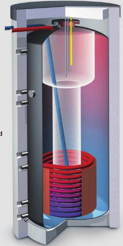
Der Tank-in-Tank-Kombi-Speicher Termo weist geringe Wärmeverluste auf und vereint zwei Anwendungen: Das Trinkwasser befindet sich im emaillierten Innentank, während der äußere Speicher das warme Heizungswasser bereitstellt. www.wagner-solar.com
