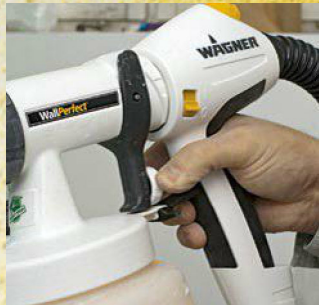
14. Nun wird die Materialflussmenge am Gerät eingestellt, dann die Düse je nach gewünschtem ...
