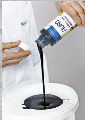
5. Die dritte Komponente besteht aus 0,5 kg schwarzer Voll- und Abtönfarbe.
