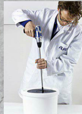
6. Alles wird mit Hilfe eines elektrisch angetriebenen Rührkorbes vermischt.
