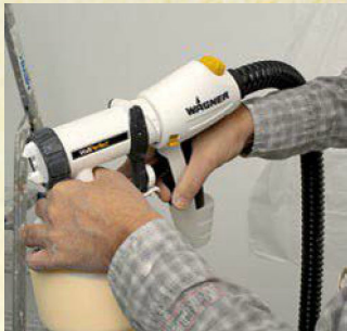
13. ... direkt in den Sprühbehälter gegeben werden. Dieser wird dann am Sprühgerät angeschlossen.
