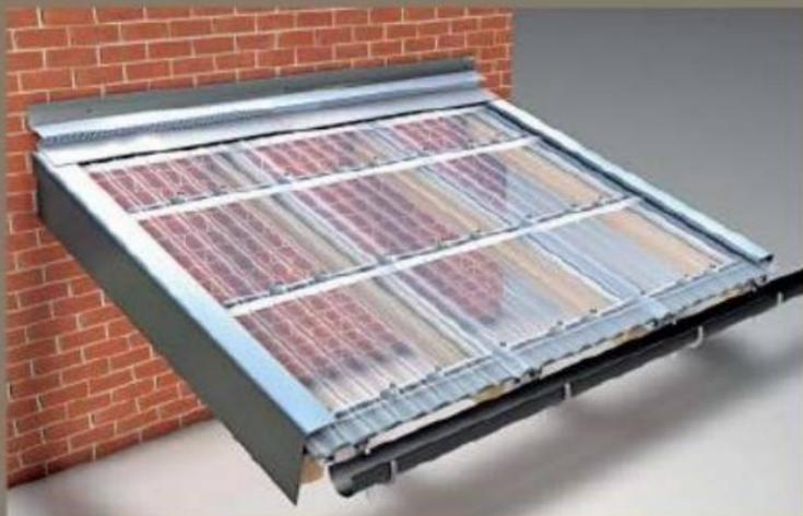
Die Alu-Gleitprofile liegen längs auf den Sparren, die Dachlatten-Gleitprofile hingegen waagrecht. Damit die Gleitschlitten nicht herausrutschen, werden Bremsschlitten verschraubt.
