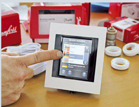
13. Nächster Arbeitsschritt für den Heizungsinstallateur: Konfiguration des mit Farbtouchscreen ausgestatteten zentralen Bedienteils.
