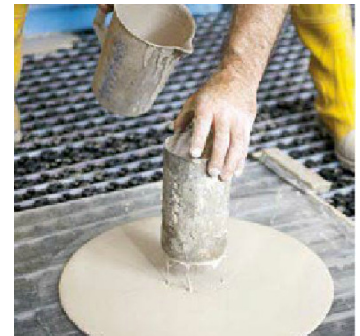
5 Das richtige Fließmaß zeigt an, ob die Materialkonsistenz der Nivelliermasse passt.
