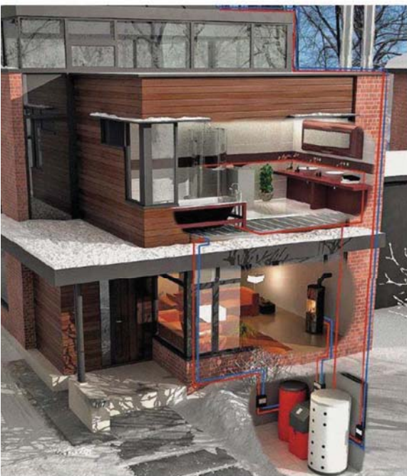
Heizungsunterstützung vom Wohnraum aus: Ein wasserführender Kaminofen oder Kamineinsatz hilft die Brennstoffkosten für Öl und Gas spürbar zu reduzieren. Die Installation ist auch ergänzend zu einer Solarwärmanlage sinnvoll. www.rokossa-energy.com
