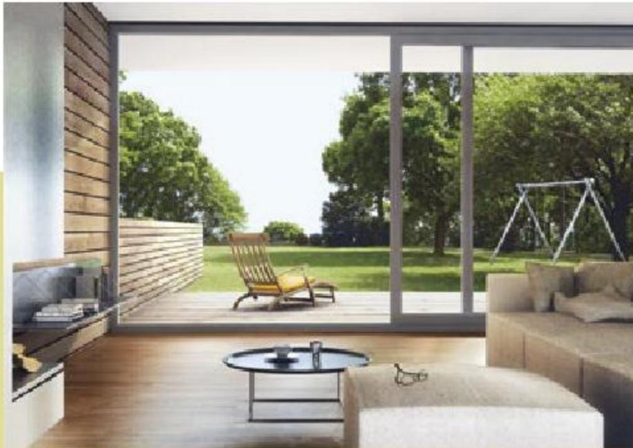
Geklebte Schiebe-Scheibe: Dank Trockenverklebung der Scheibe im Kunststoffrahmen können solch große Anlagen mit stabilen raumhohen Schiebe-Elementen hergestellt werden. [www.inoutic.de](http://www.inoutic.de)
