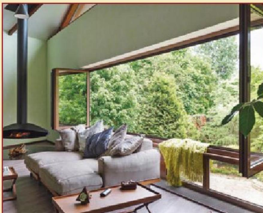
Glas-Faltwände lassen sich auch dort einbauen, wo kein Austritt möglich oder gewünscht ist. Das eindrucksvolle Element hier beispielsweise ist ein raumbreites faltfenster. Es öffnet den zentralen Wohnraum meterweit zur Natur hin und flutet ihn mit Licht. Hier wurde eine nach rechts und links sowie nach innen auffaltende Anlage gewählt. Die ebenfalls raumbreite Festverglasung unterhalb bietet Sicherheit und lässt dennoch den Blick frei nach draußen. [www.solarlux.de](http://www.solarlux.de)
