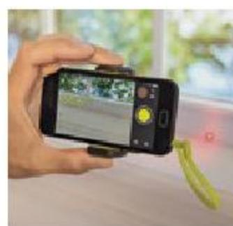
Beim Einsatz als Thermometer erfasst das Gerät die jeweilige Oberflächentemperatur des Materials.
