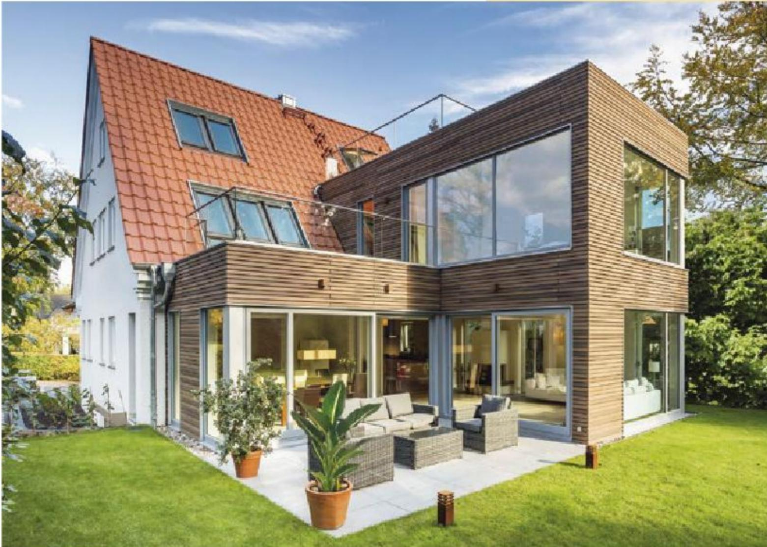
Dieser Anbau an ein Haus aus dem Jahr 1939 fußt auf einer Holzrahmenbauweise. Er hat eine Nutzfläche von rund 76 Quadratmetern, dazu kommen zwei Dachterrassen auf unterschiedlichen Geschossen. Die Wände der neuen Räume bestehen fast ausschließlich aus Glas – entsprechend gut sind die Belichtung und die Sicht in den Garten. Die Fassadenlatten des Anbaus bestehen übrigens zu 60 Prozent aus Reishülsen. [www.resysta.de](http://www.resysta.de)
