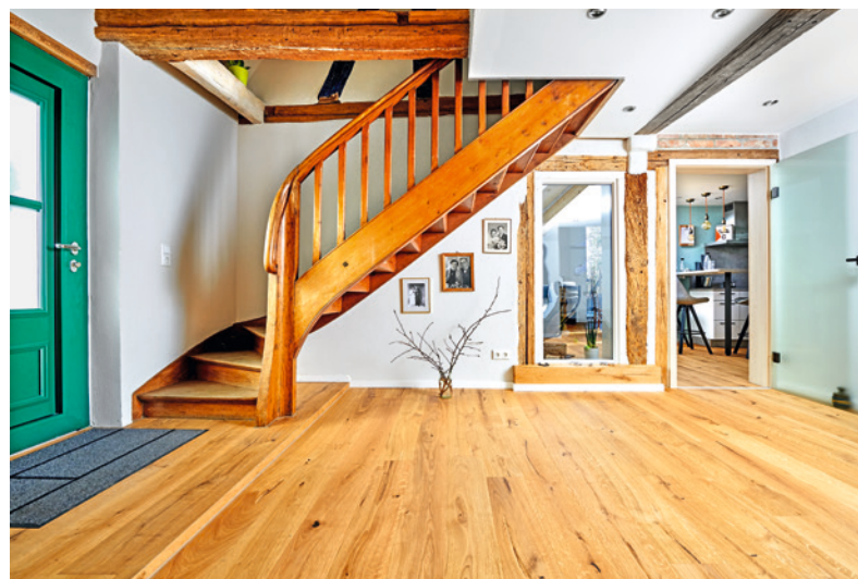
Passender Abschluss: Das neue Eichenparkett, geölt aber nicht versiegelt, harmoniert mit den aufgearbeiteten historischen Holzteilen.
