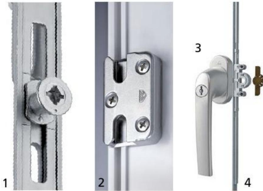
Das System „Quadro Safe“ erhöht den Einbruchschutz von Fenstern. Anstelle herkömmlicher Zapfen und Schließstücke kommen Pilzkopf-Sicherheitschließzapfen (1) mit mehrfach verschraubten Sicherheitsschließstücken (2) zum Einsatz. Der abschließbare Fenstergriff (3) verhindert, dass sich der Beschlag von außen verschieben oder so entriegeln lässt. Einen zusätzlichen Schutz des Getriebes gegen Aufbohren bietet der unsichtbar auf der Außenseite angebrachte Anbohrschutz (4). Roto
