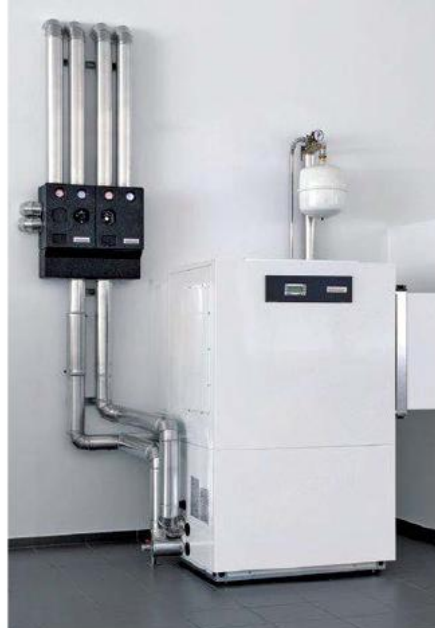
Luft/Wasser-Wärmepumpen, die im Gebäude stehen, benötigen zwei getrennte Luftkanäle für die Außen- und Abluftführung. Praktisch dafür ist die Eckaufstellung. Weishaupt
