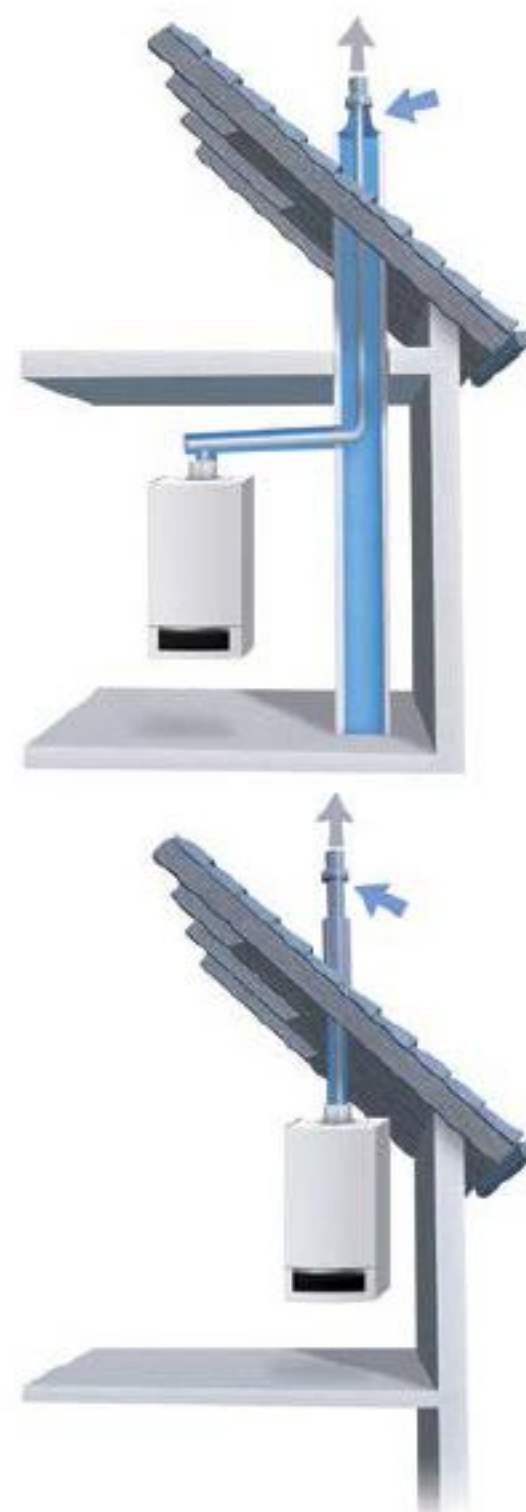
Bei der Schornsteinsanierung in Verbindung mit Brennwertgeräten sehr beliebt ist der Einsatz von preiswerten Abgasleitungen aus Kunststoff (hier als LAS-Ausführung). Unterm Dach kann die Ableitung der Abgase auch ohne Schornstein erfolgen. Buderus
