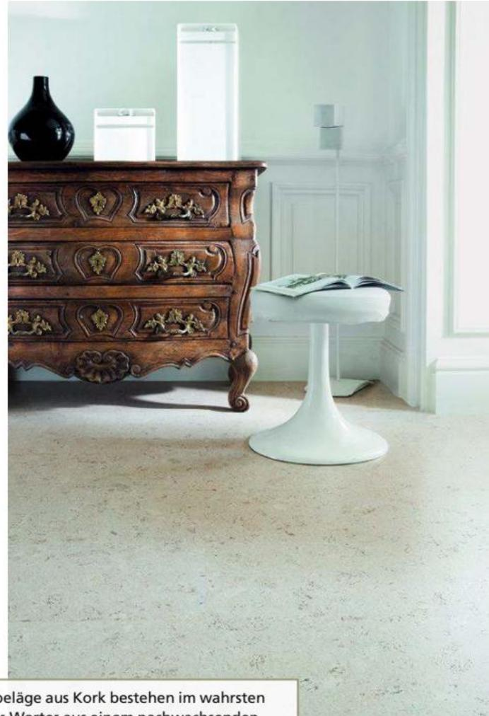
Bodenbeläge aus Kork bestehen im wahren Sinn des Wortes aus einem nachwachsenden Rohstoff: der Rinde der mediterranen Korkeiche, die alle neun Jahre geschält wird. Danach ist wieder genug Rinde nachgewachsen. Korkbeläge sind trittelastisch, schalldämmend, fußwarm und schmutzabweisend. Das Naturmaterial wird als Platten auf dem Untergrund verklebt. Alternativ dazu gibt es auch Korkparkett, das schwimmend verlegt wird. APCOR/Deutscher Kork-Verband
