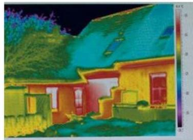
Die professionell durchgeführte Infrarot-Thermografie ist eine gute Möglichkeit, um die Gebäudehülle auf energetische Schwachstellen zu durchleuchten. KfW-Bildarchiv
