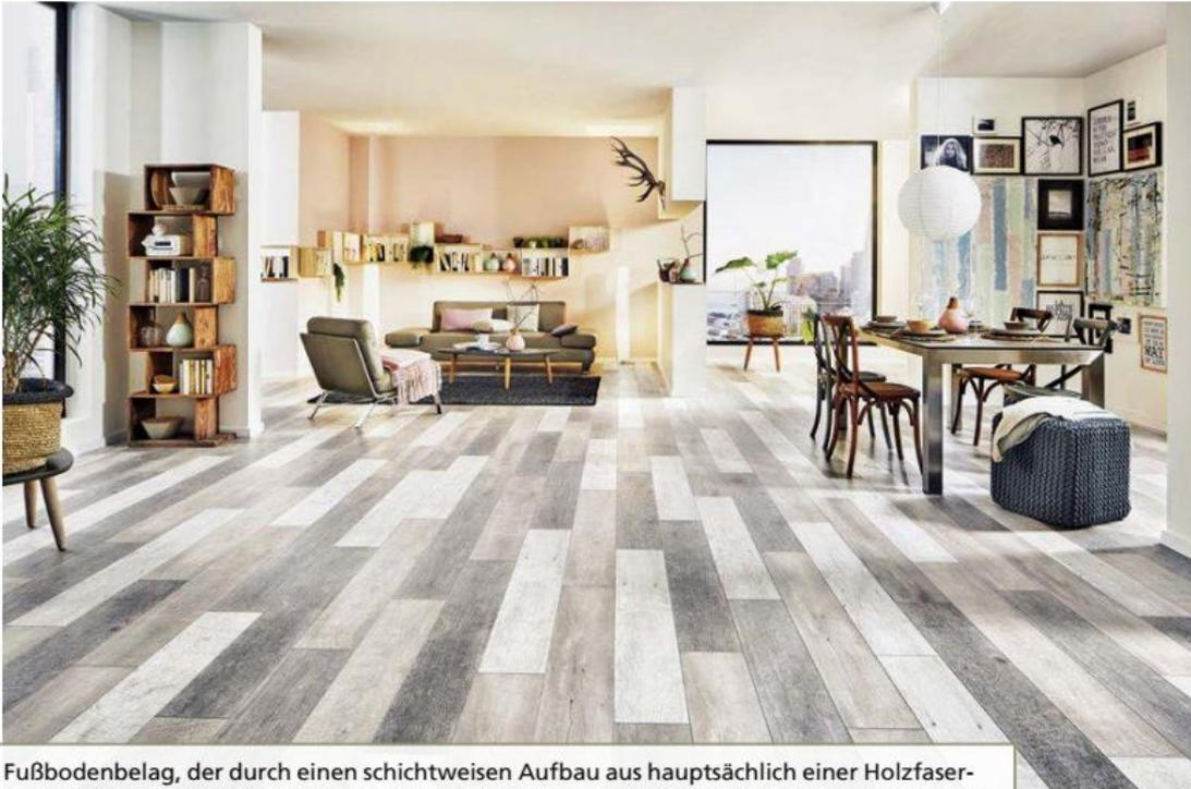
Laminat ist ein Fußbodenbelag, der durch einen schichtweisen Aufbau aus hauptsächlich einer Holzfasersplatte, Papier und Klebstoff besteht. Die Stärke des Belags liegt in seiner Wandlungsfähigkeit. Beispiel: Die Logoclic-Laminatböden der Serie „Vinto“, die exklusiv bei Bauhaus erhältlich sind, besitzen eine täuschend echte Holzoptik, mit denen Natürlichkeit in den Raum einzieht. Einmal verlegt, verleihen die Langdielen eine großzügige Atmosphäre. Und: Laminatböden sind äußerst robust. Logoclic
