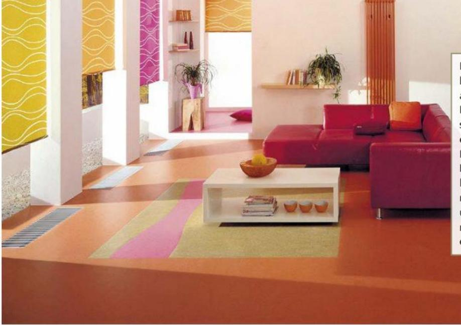
Linoleum ist seit 130 Jahren ein Bodenbelagsklassiker. Es besteht aus 98 Prozent aus natürlichen Rohstoffen: Leinöl, Baumharze, Kork, Holzmehl sowie Kalksteinpulver werden verknüpft und auf eine Trägerschicht aus Jute gewalzt. Linoleum ist beliebt wegen seiner breiten Farbpalette – von elegant bis farbenfroh leuchtend – und wegen seiner technischen Eigenschaften: Es ist pflegeleicht und reinigungsfreundlich, elastisch sowie rutschhemmend und bietet dadurch einen hohen Gehkomfort. DLW Flooring
