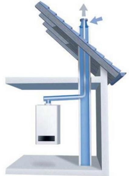
Um ein neues Öl- oder Gas-Brennwertgerät am alten Hausschornstein nutzen zu können, muss ein Kunststoff- oder Edelstahlrohr in den Schornsteinzug eingezogen werden. Buderus
