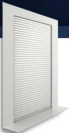
So elegant kann Einbruchschutz sein. Die Rollladenstäbe heroal RS 37 RC 3 sind aus einer Edelstahl-Legierung rollgeformt und mit einem dauerbeständigen Zweikomponenten-Integralwerkstoff gefüllt. Damit erreichen sie DIN-geprüft die Widerstandsklasse RC 3 – und in Verbindung mit entsprechenden Fenstern sogar RC 4. Außerdem bieten sie maximalen Hagelschutz. Eine Lösung, die Ihr Haus „Einfach. Besser.“ sichert und gleichzeitig noch gut aussieht.
