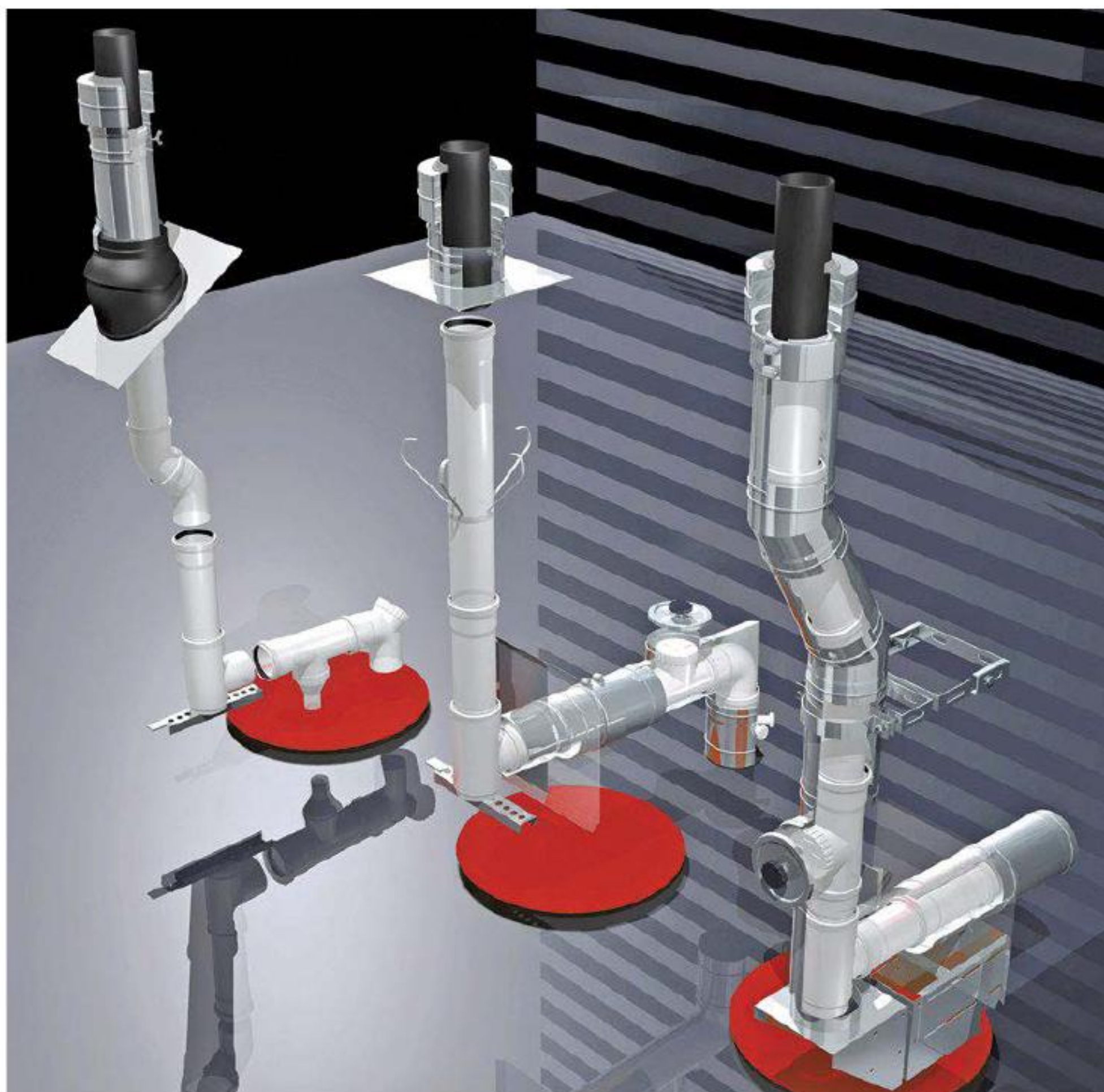
Wird erstmals ein Brennwertgerät installiert, ist der alte Schornstein sanierungsbedürftig. Dazu werden vor allem Kunststoffrohre eingesetzt. Ein eventuell notwendiger neuer Edelstahl-Schornstein (rechts) lässt sich an der Hausfassade entlangführen. Schröder
