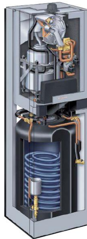
Damit die Mikro-KWK-Anlagen längere Laufzeiten erreichen, werden sie mit Pufferspeichern kombiniert. Ein 175-Liter-Modell ist beim 1-kW-System „Vitotwin 350“ (Heizleistung bis 26 kW) bereits integriert. Viessmann
